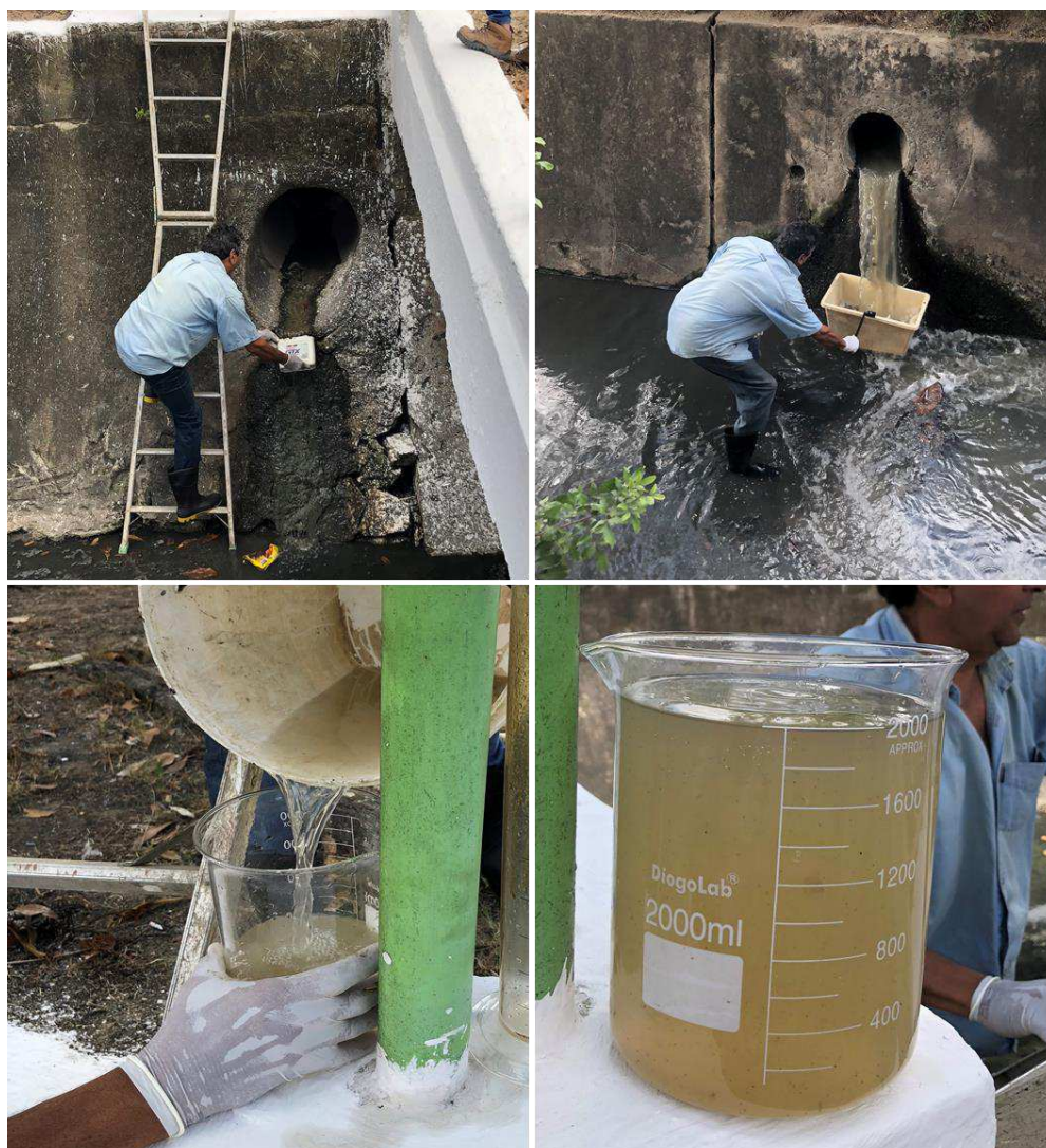
Figura 15 – Método de determinação da vazão de entrada de esgoto.
