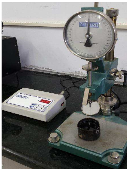
Figura 27 - Ensaio de penetração sendo executado
