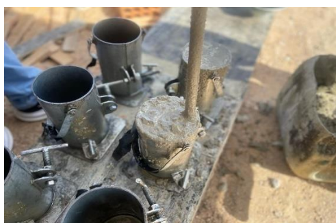
Figura 9 - Última camada do corpo de prova sendo submetida a 12 golpes. (Fonte: Autoria própria, 2023).
