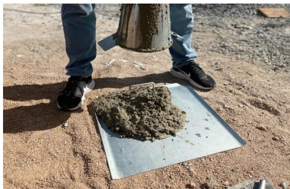
Figura 8 - Resultado obtido após a elevação do cone no Slump Test. (Fonte: Autoria própria, 2023).
