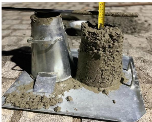
Figura 18 – Ensaio de Slump Test. (Fonte: Autoria própria, 2023).
