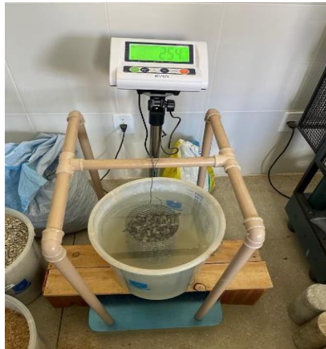
Figura 13 – Ensaio de Massa Específica. (Fonte: Autoria própria, 2023).
