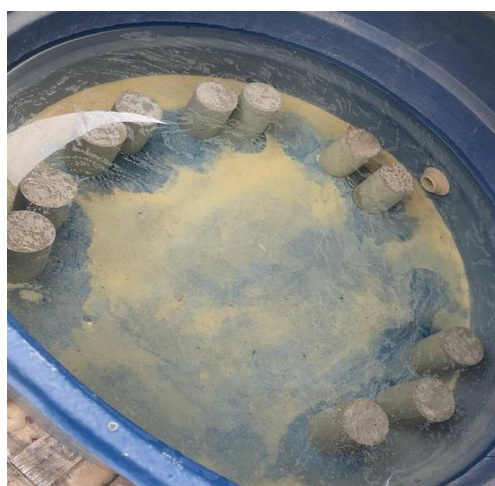
Figura 11 - Corpos de prova imersos em água como parte do processo de cura. (Fonte: Autoria própria, 2023).
