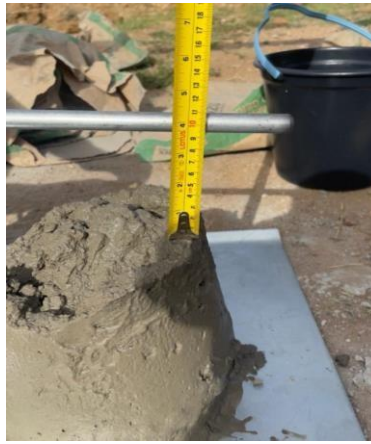
Figura 4 - Concretização ensaio de Slump Test, exibindo a medida do abatimento do concreto. (Fonte: Autoria própria, 2023).
