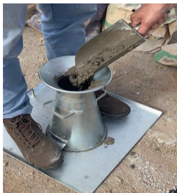
Figura 3 - Preenchimento do cone de abatimento no ensaio de Slump Test. (Fonte: A autoria própria, 2023).
