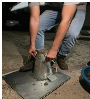
Figura 6 - Aguardo do tempo recomendado pela norma para elevar o cone no Slump Test. (Fonte: Autoria própria, 2023).
