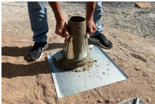
Figura 7 - Elevação do cone durante o ensaio de Slump Test. (Fonte: Autoria própria, 2023).
