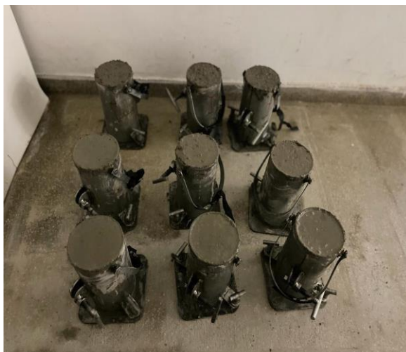
Figura 19 – Corpos de prova para as três resistências. (Fonte: A autoria própria, 2023).
