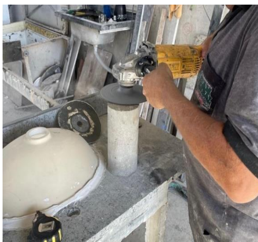
Figura 10 - Processo de retificação dos corpos de prova. (Fonte: Autoria própria, 2023).
