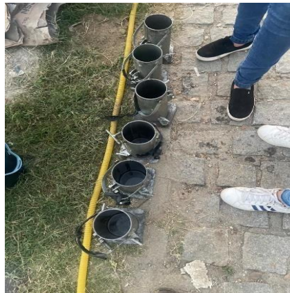
Figura 5 - Momento subsequente à aplicação do agente desmoldante nos corpos de prova. (Fonte: Autoria própria, 2023).
