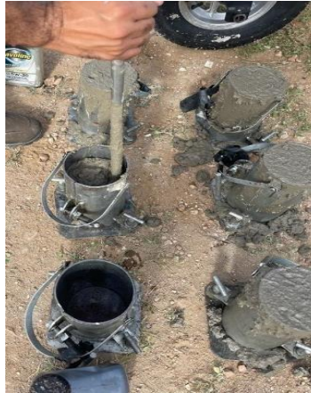
Figura 1- Processo de enchimento e compactação do corpo de prova. (Fonte: A autoria própria, 2023).
