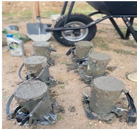
Figura 2 - Corpos de prova recém preenchidos e iniciando o aguardo de 24 horas para desmoldar. (Fonte: A autoria própria, 2023)
