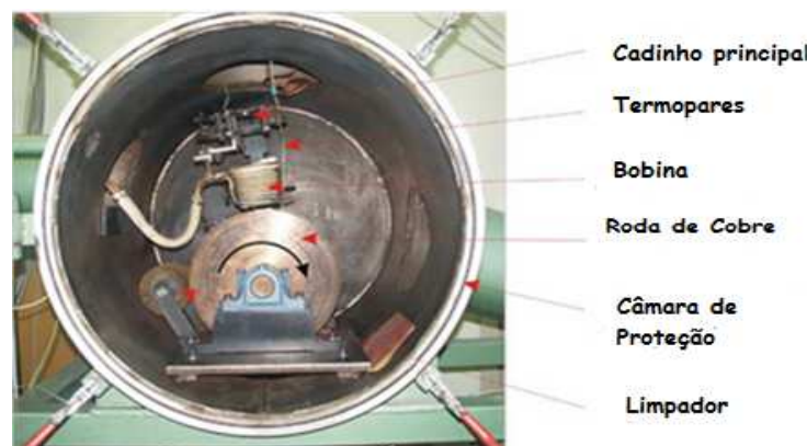
Figura 8. Equipamento de fabricação de fitas por meio da solidificação rápida por injeção de metal líquido em volante de cobre ( Melt Spinning ).
