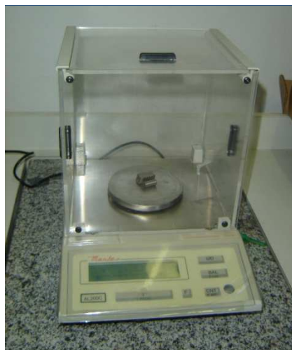
Figura 34. Balança de precisão Marte, modelo AL200C, máximo de 200g e mínimo de 0,02g.
