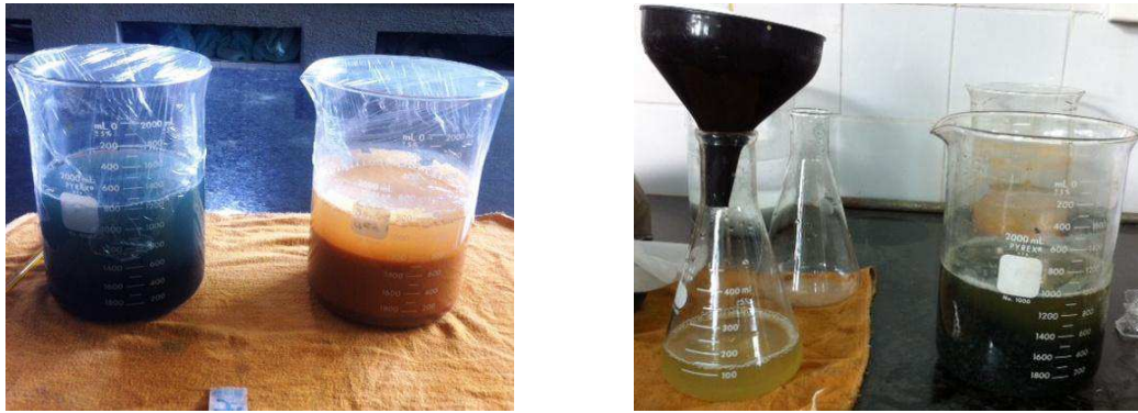
Figura 42 – Amostras em repouso e filtragem
