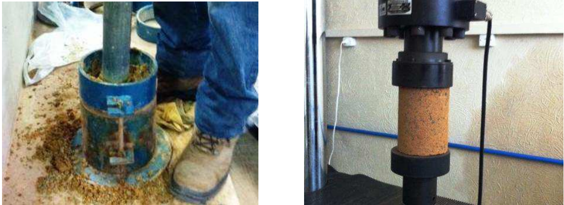
Figura 24 - Ensaio de RCS: compactação e rompimento do corpo de prova
