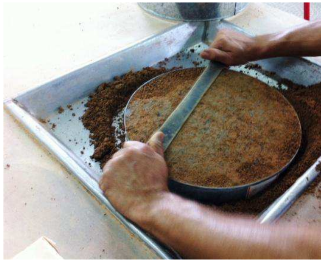
Figura 36 - Corpo de prova sendo nivelado
