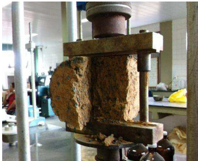
Figura 29 - Corpo de prova rompido RT
