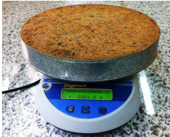
Figura 37 - Pesagem corpo de prova
