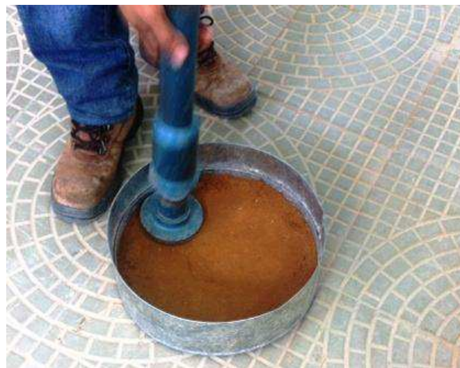
Figura 35 - Compactação corpos de prova WTAT
