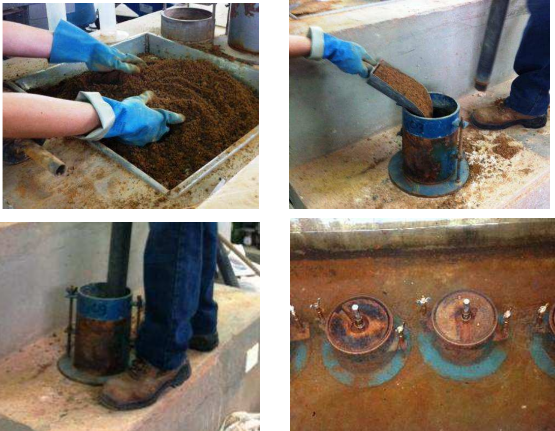
Figura 22 - Ensaio de ISC: mistura, moldagem e imersão
