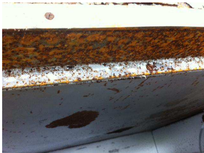
Figura 67 - Estufa depois da secagem do lodo
