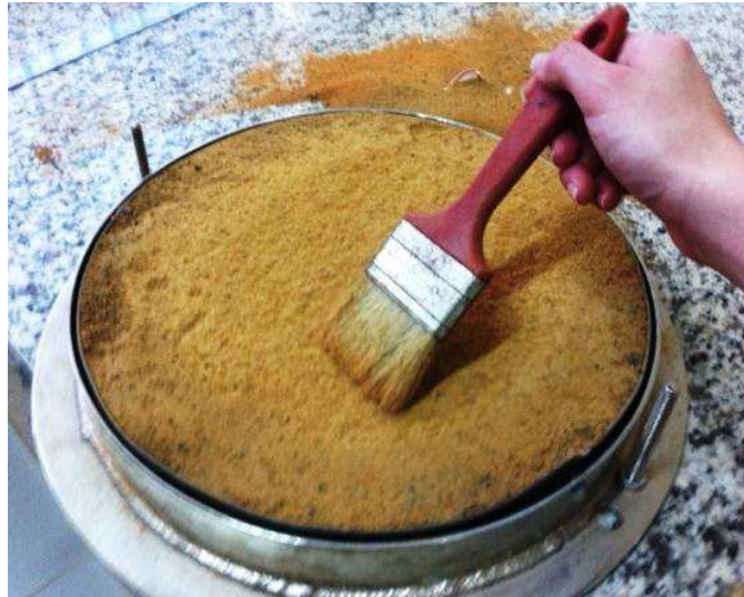
Figura 39 - Material desprendido retirado com ajuda de pincel
