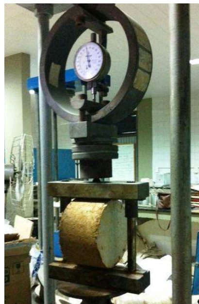
Figura 26 - Compactação corpo de prova para o ensaio RT
