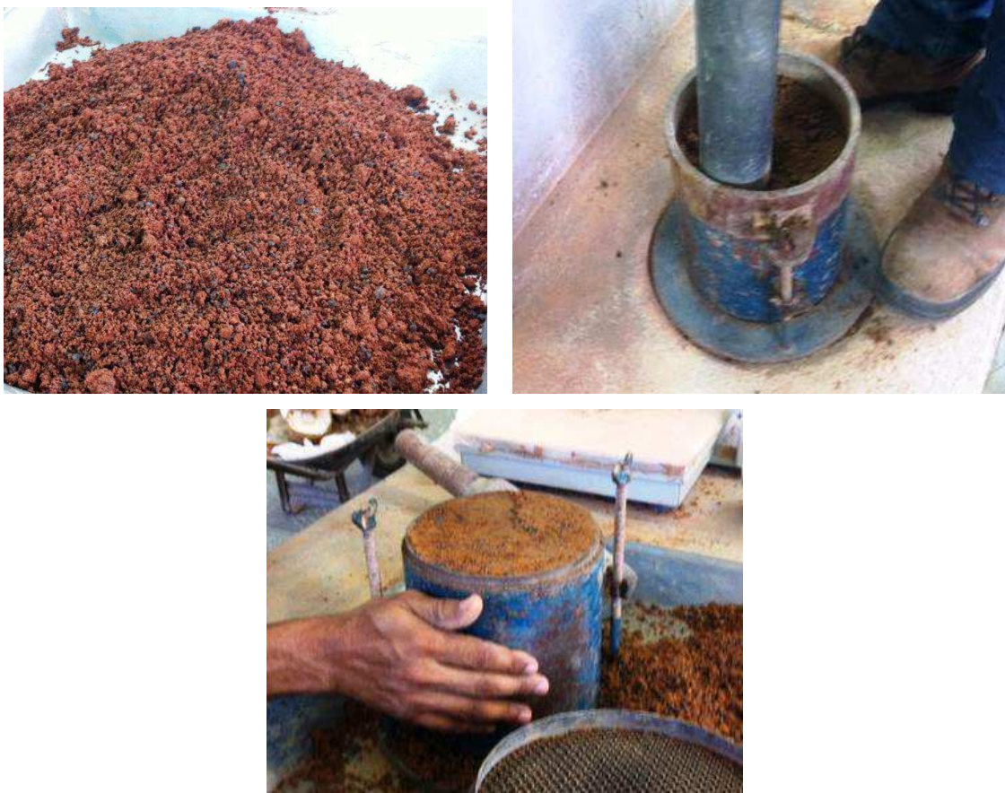
Figura 21 - Ensaio de Compactação: mistura, compactação e moldagem
