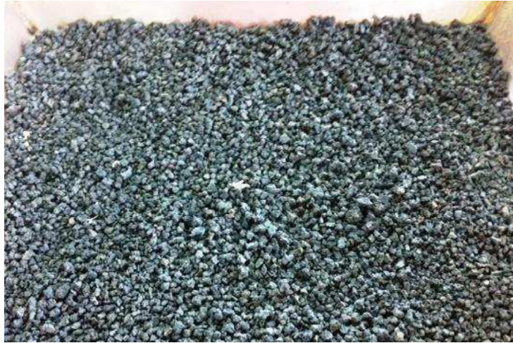
Figura 12 - Lodo seco em estufa e destorroado
