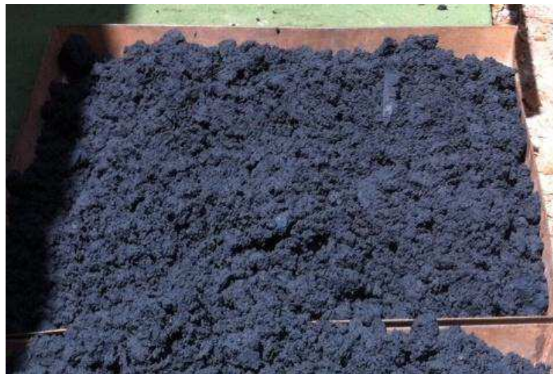
Figura 11 - Secagem prévia do lodo têxtil
