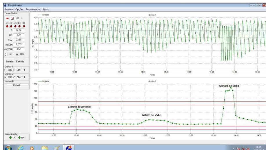
Figura 4.12: Respirograma para determinar o metabolismo das bactérias heterotróficas e autotróficas
