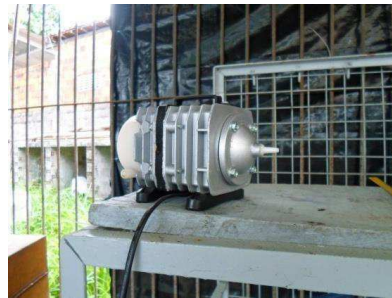
Figura 3.4 : Aeradores utilizados nos sistemas
