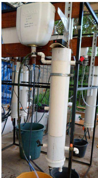
Figura 3.5: Foto do sistema RBS- unitário
