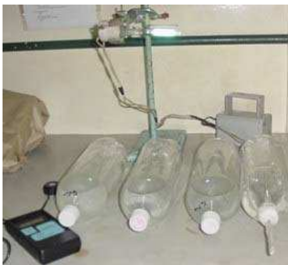
Figura 4.2: Lâmpada germicida e exposição das garrafas PET com água inoculada com os microrganismos sob estudo – (UNICAMP).
