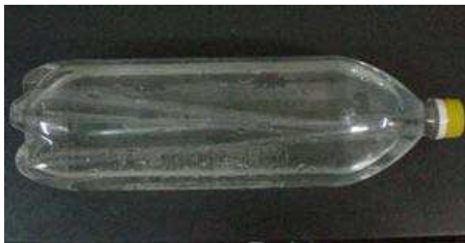
Figura 4.8: Garrafa PET contendo os bastões de quartzo com filme de \text{TiO}_2 dopados com nitrogênio
