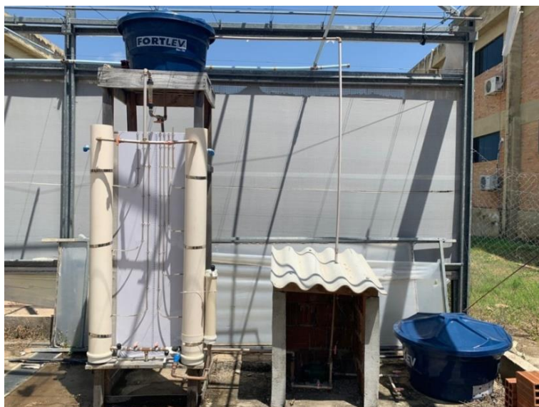
Figura 25 - Sistema experimental de tratamento de água, contemplando as etapas de filtração lenta e adsorção.
