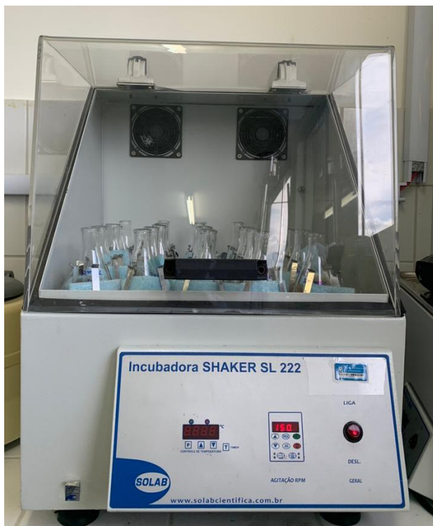
Figura 23 - Mesa agitadora utilizada nos ensaios de cinética e isotermas de adsorção.
