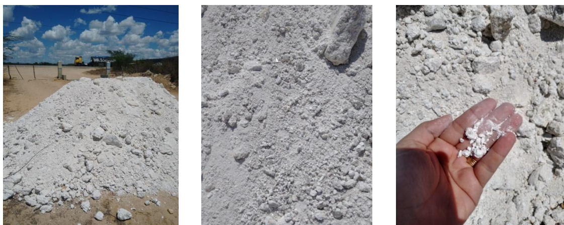
Figura 16 - Resíduos da mineração de caulim dispostos em estrada vicinal às margens da BR- 230.
