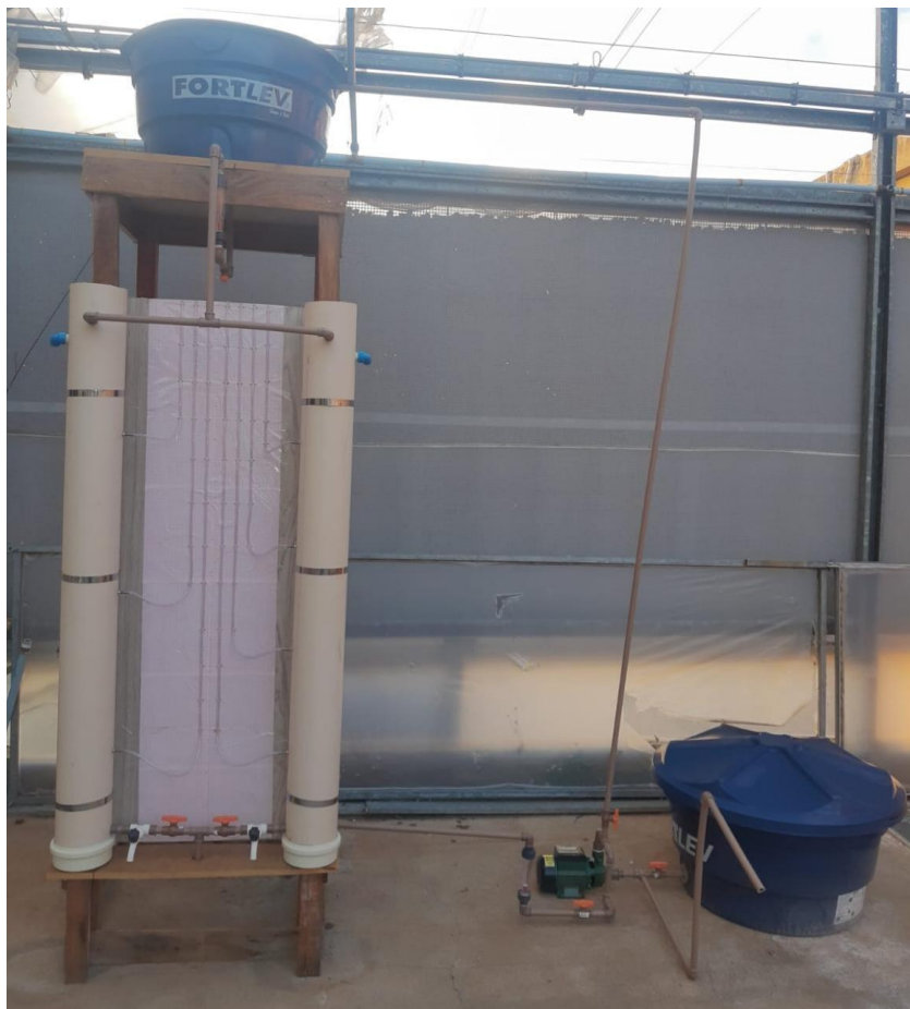
Figura 15 – Sistema experimental de filtração lenta e retrolavagem.
