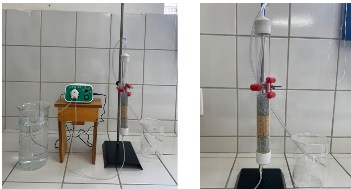
Figura 24 - Coluna de adsorção em escala de laboratório.
