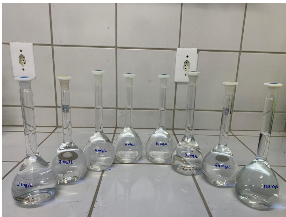
Figura 22 - Soluções utilizadas nos ensaios de isotermas de adsorção.
