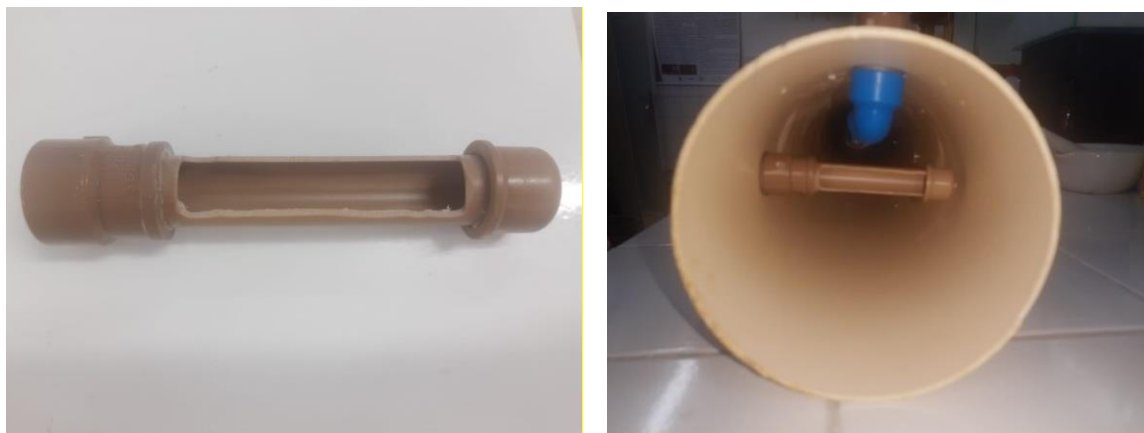
Figura 13 - Detalhes da calha de coleta de água de lavagem.
