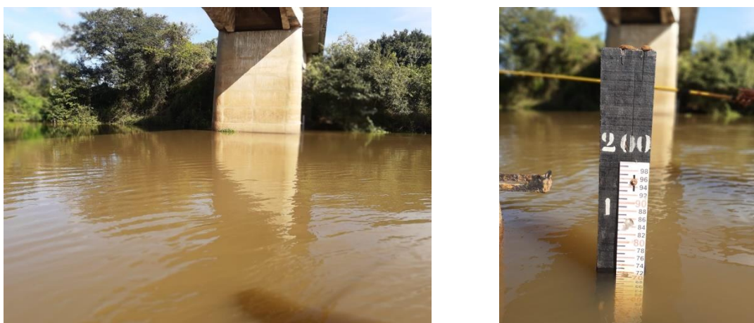
Figura 10 - Ponto de coleta de água bruta no rio Piranhas e régua limnimétrica para medição do nível de água.
