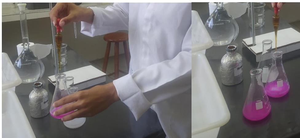
**Figura 4:** Procedimento de Titulação da Respiração microbiana do solo. Erlenmeyer contendo solução NaOH 0,5 mol L<sup>-1</sup> (previamente incubada com o solo) + 10 mL da solução BaCl<sub>2</sub> 0,05 mol L<sup>-1</sup> e adição de três gotas de Fenolftaleína 1%.
