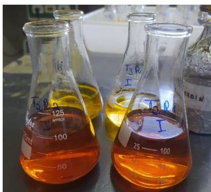
**Figura 5:** Procedimento de titulação do carbono da biomassa, Erlenmeyer com 2 ml da solução de  $K_2Cr_2O_7$   $0,066 \text{ mol L}^{-1}$  + 10 ml de  $H_2SO_4$  + 50 ml de  $H_2O$  destilada + três gotas do ferroin como indicador e titulação com sulfato ferroso amoniacal  $0,03 \text{ mol L}^{-1}$ . Em detalhe, ponto de viragem, passando de amarelo para um tom alaranjado.
