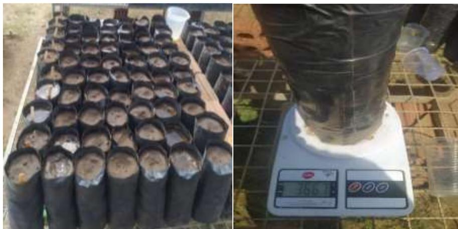
**Figura 3.** Capacidade de campo do solo e lisimetria de pesagem das plantas irrigadas com 100% da Evapotranspiração Real - ETr.
