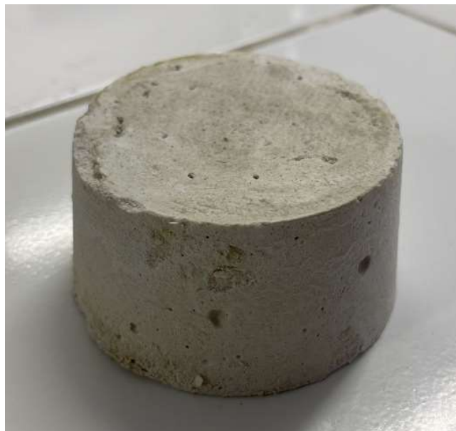
Figura 12 – Amostra do composto de gesso com 30% de incorporação de caldo de cana de açúcar na água de amassamento
