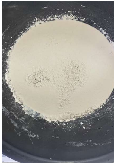
Figura 2 – Gesso em repouso na água de amassamento
