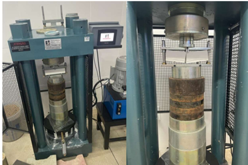
Figura 8 – Ensaio de resistência à tração na flexão.
