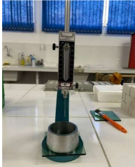
Figura 3 - Aparelho de Vicat utilizado para o ensaio de determinação do tempo de pega.
