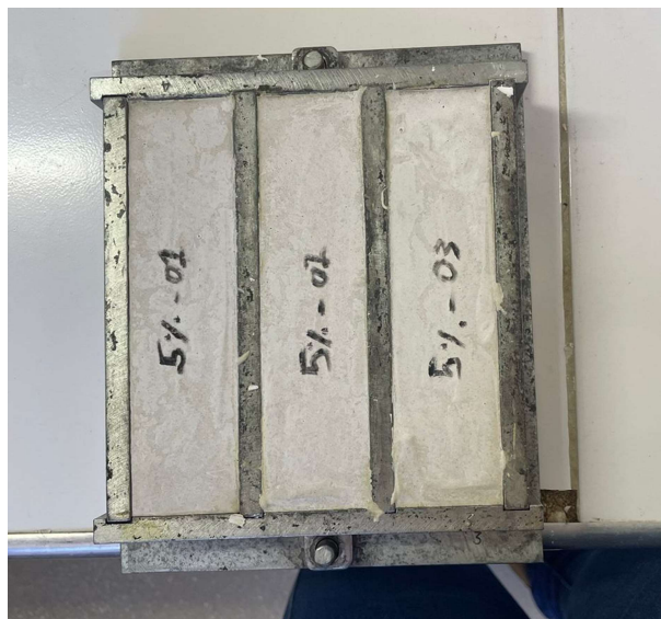
Figura 7 - Molde de corpos de provas prismáticos
