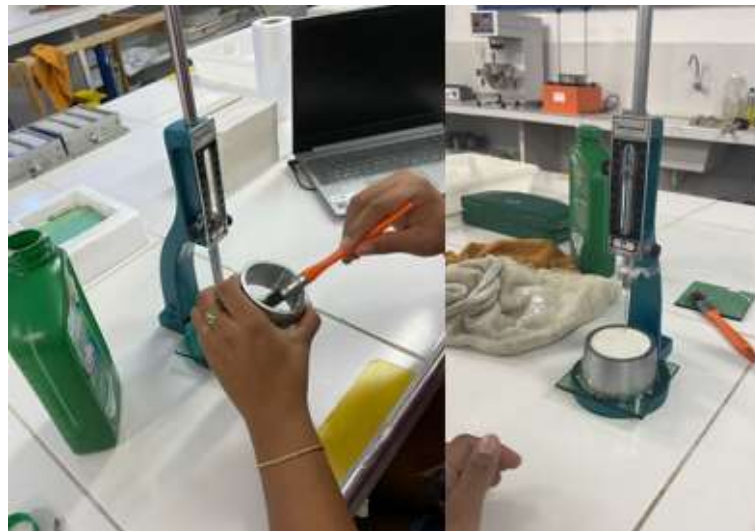
Figura 4 – Preparação do Ensaio do Tempo de Pega
