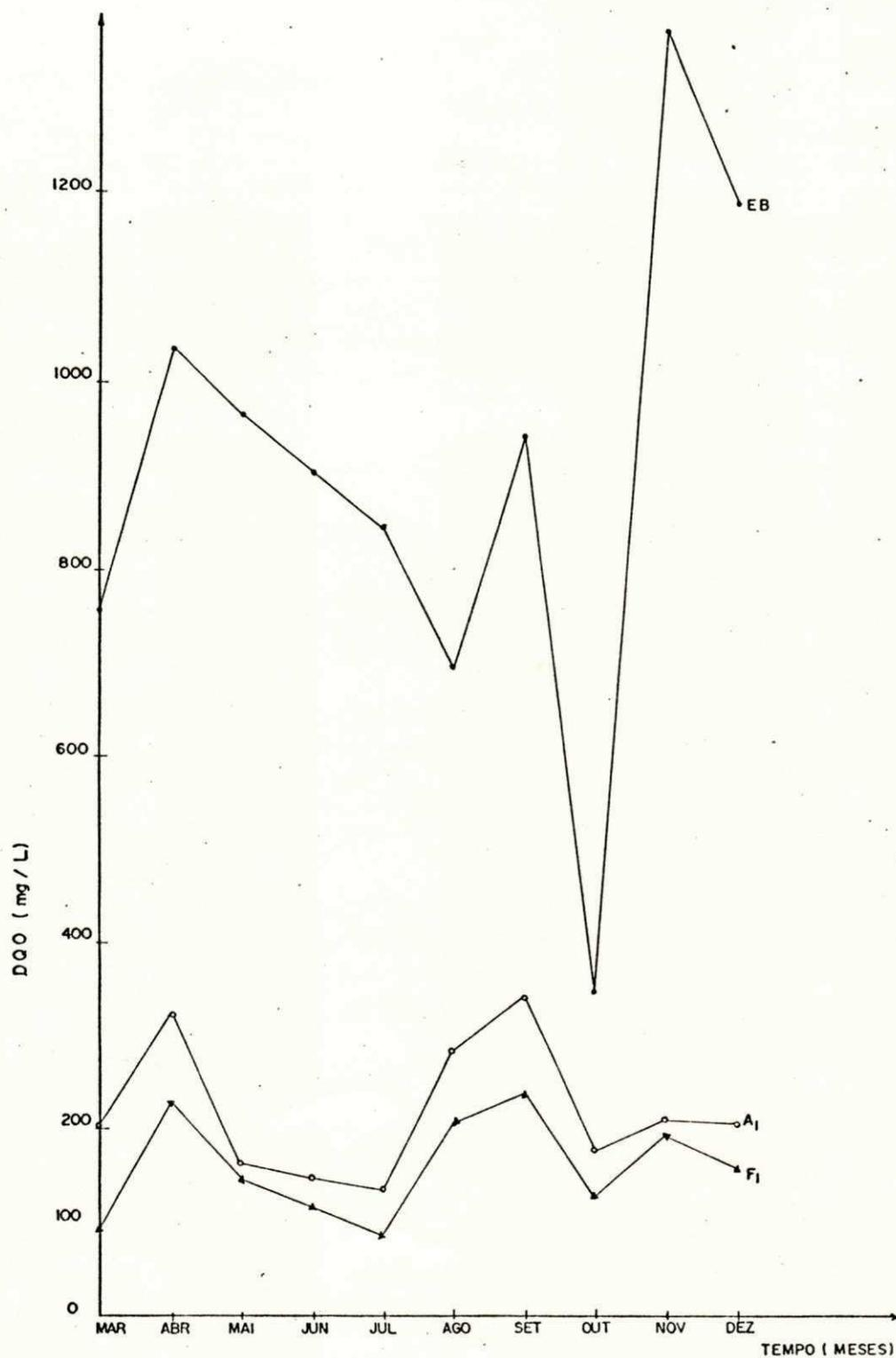
Figura 4.11 - Média mensal da concentração de DQO no esgoto bruto (•) e efluentes das lagoas anaeróbia (o) e facultativa (▲) da ETE de Guarabira - Pb, no período de março a dezembro de 1990.
