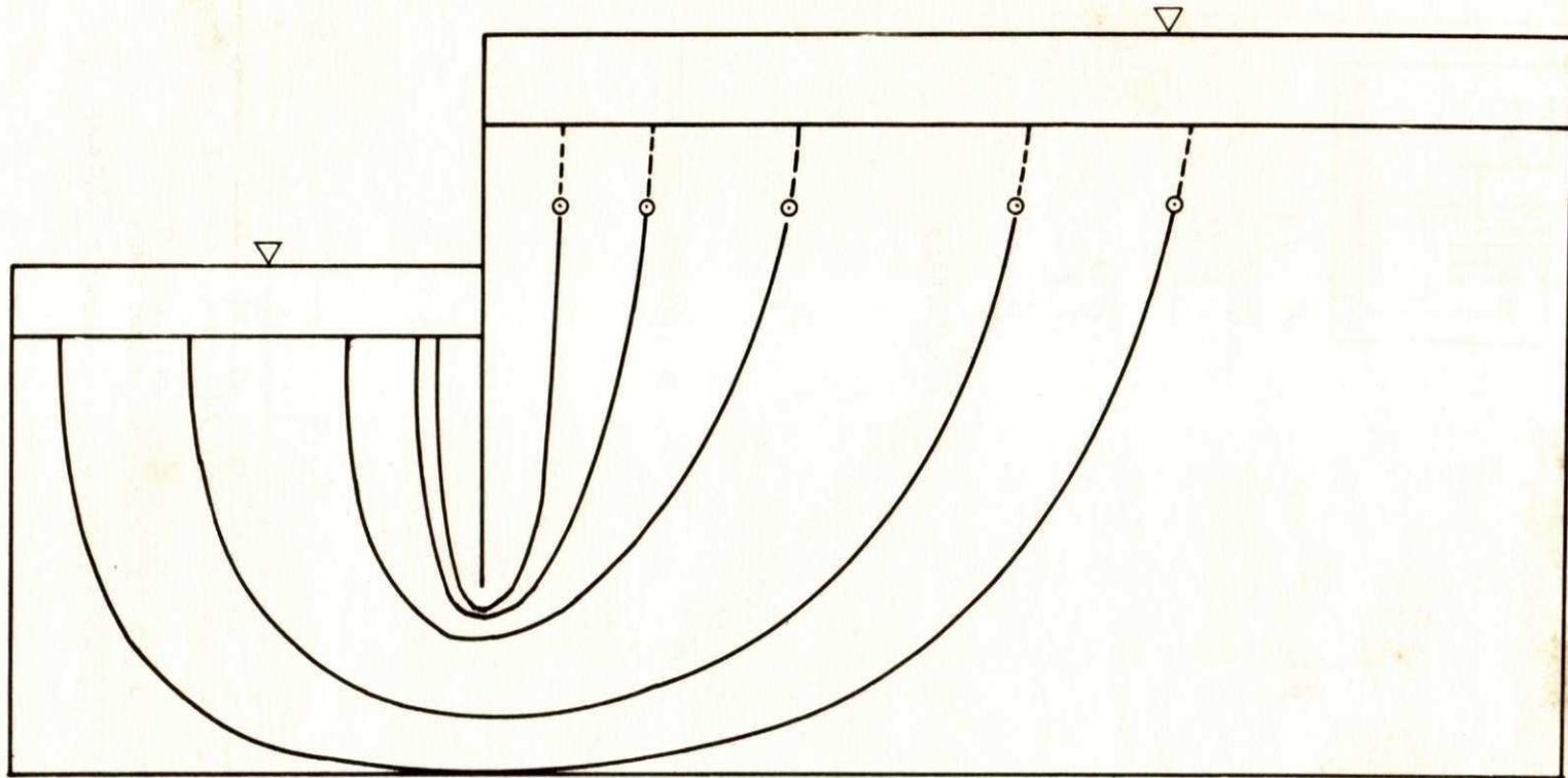
Fig. 5.2 - Padrão de linhas de corrente obtido experimentalmente
