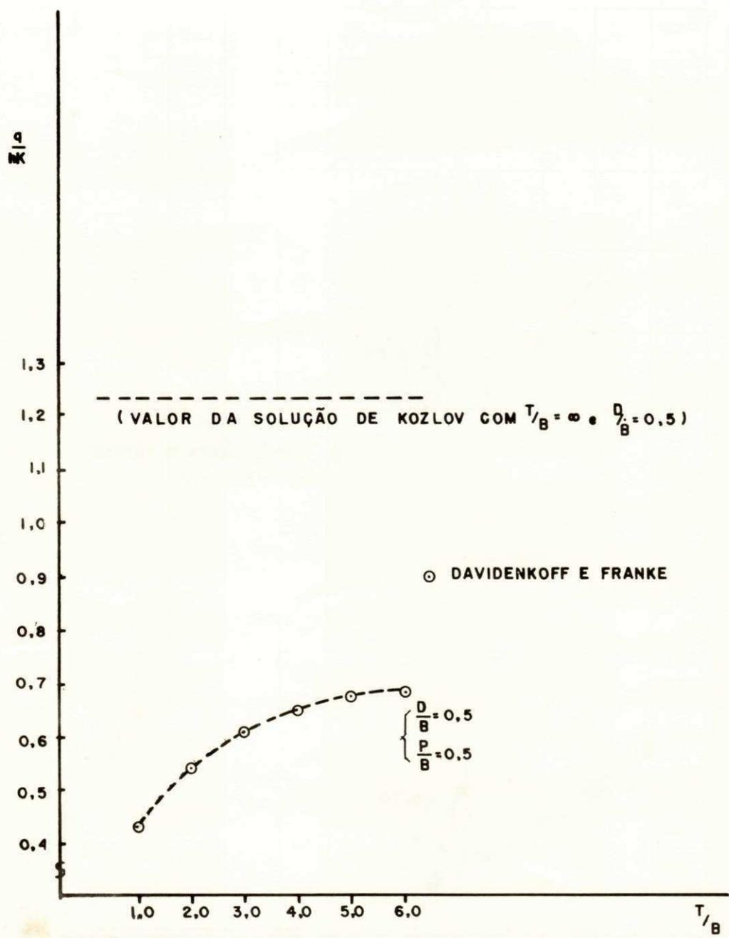
Figura 5.8 - Variação relativa da vazão adimensional com espessura do meio poroso de acordo com Davidenkoff & Franke
