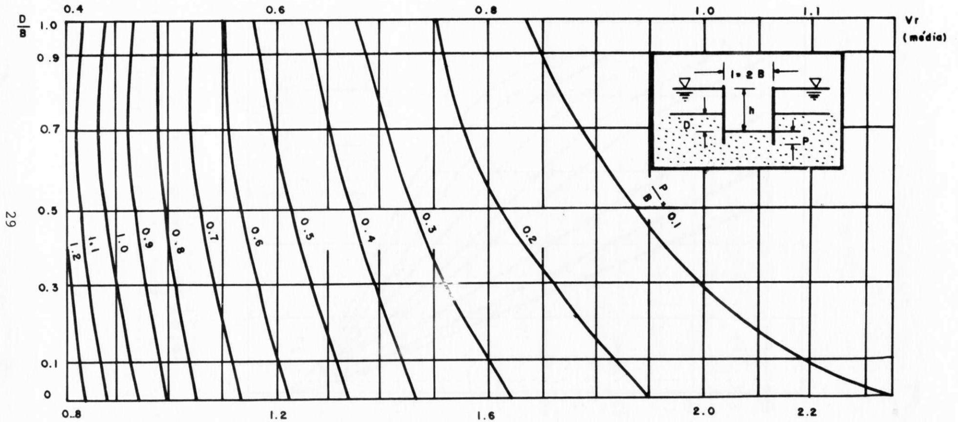
Figura 3.3 - Diagrama para determinar a velocidade dimensional ( $\frac{q}{nK}$ ) em função de  $P/B$  e  $D/B$  (segundo Kazlov, 1939)
