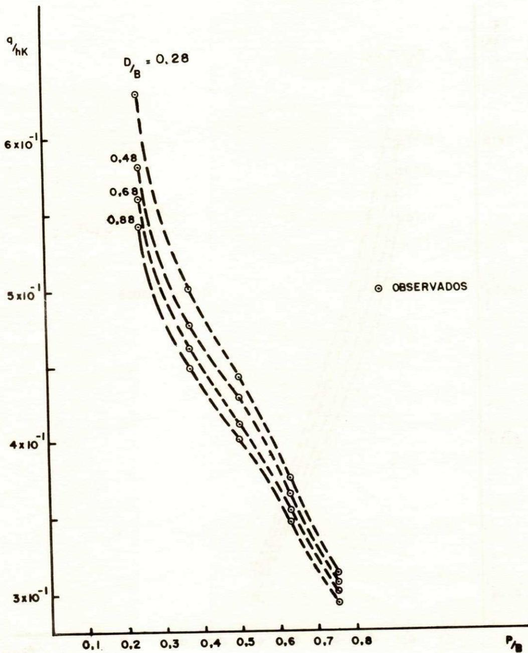
Figura 5.4 - Variação da vazão dimensional com a penetração dimensional
