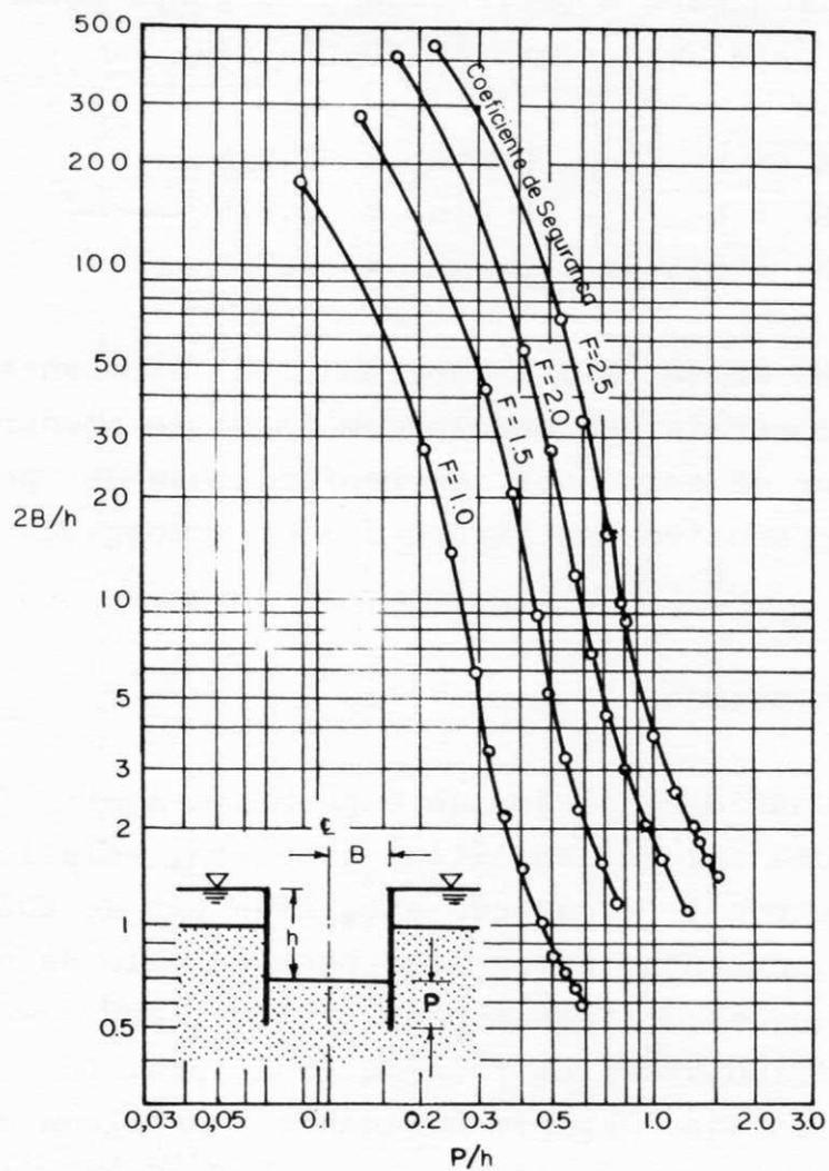
Fig. 3.2 - Profundidade de penetração,  $P$ , para escavações de diferentes larguras. (Segundo McNamee, 1949).
