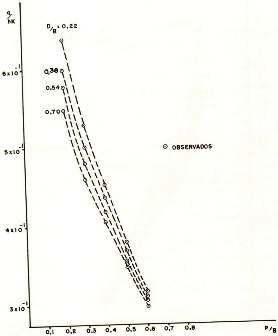
Figura 5.3 — Variação da vazão adimensional com a penetração adimensional (semilargura  $B=25,0$  cm)
