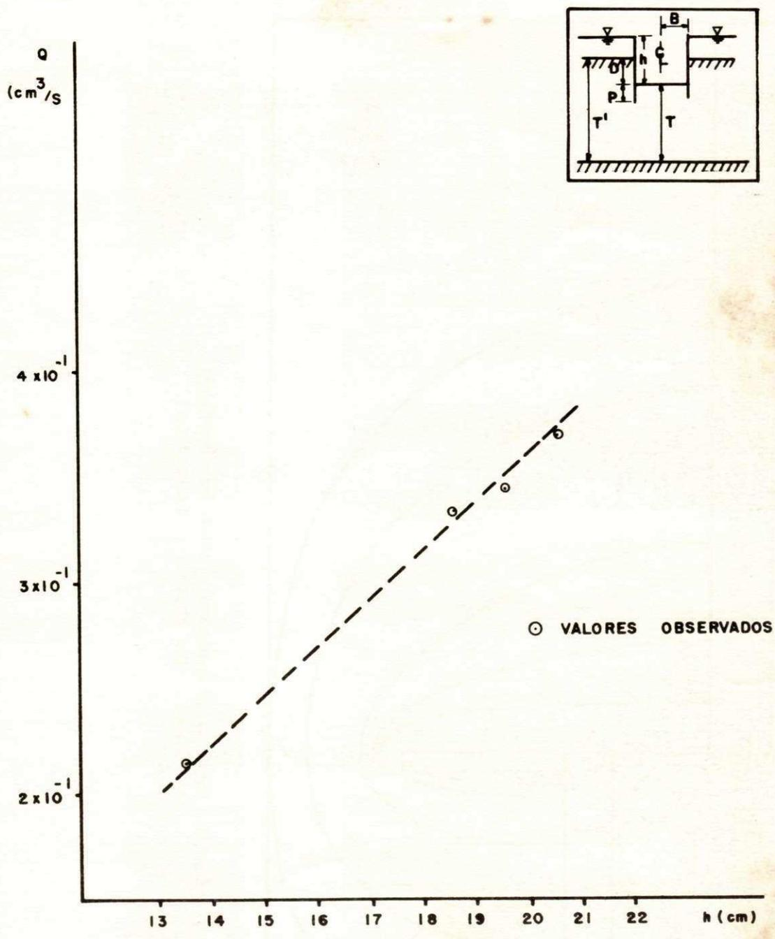
Figura 5.1 - Variação da vazão ( $Q$ ) com a carga hidráulica ( $h$ )
