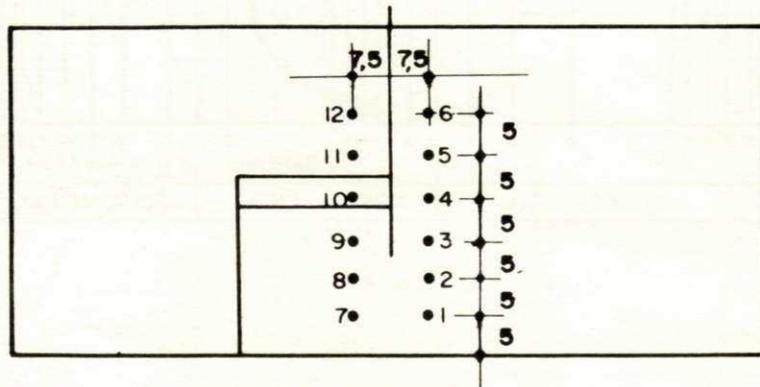
Fig. 4.4 - Localização dos piezômetros.
