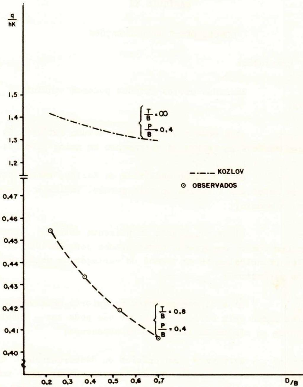
Figura 5.9 — Comparação dos resultados observados e os de Kozlov em termos de profundidade de escavação dimensional.
