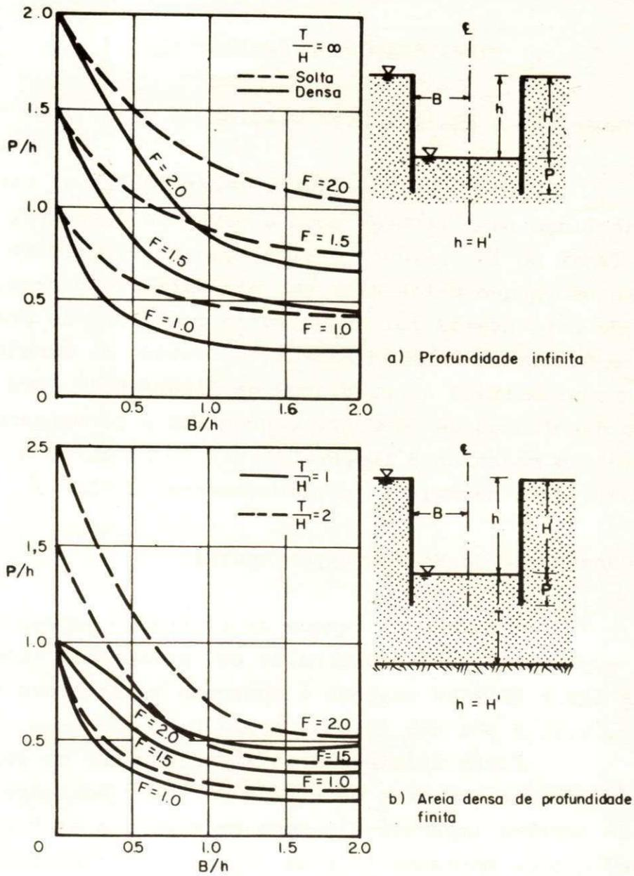
Fig. 3.5 - Profundidade de penetração,  $P$ , para diferentes coeficientes de segurança. (Segunda Marsland, 1953).
