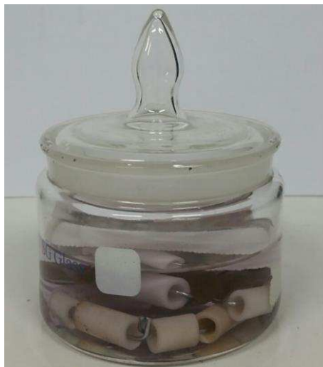
FIGURA 25 – Ensaio de resistência química das membranas tubulares poliméricas e compósitas.
