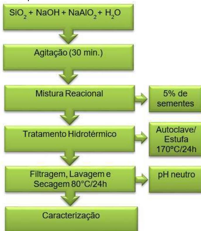
FIGURA 19 – Diagrama representativo da síntese da zeólita Mordenita.
