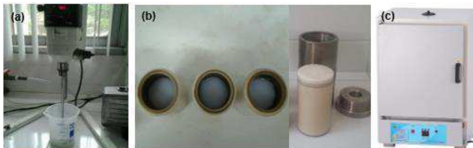
FIGURA 20 – Síntese da zeólita Mordenita: agitação da mistura reacional (a); transferência do gel (b); colocados em estufa a 170°C (c).
