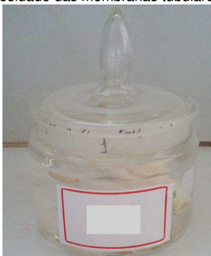
FIGURA 26 – Ensaio de porosidade das membranas tubulares poliméricas e compósitas.
