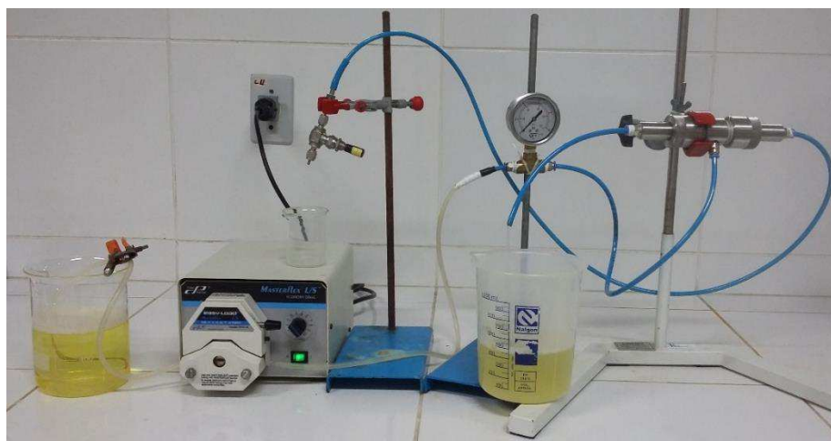
FIGURA 31 – Retrolavagem das membranas tubulares poliméricas e compósitas em fluxo de sistema contínuo.
