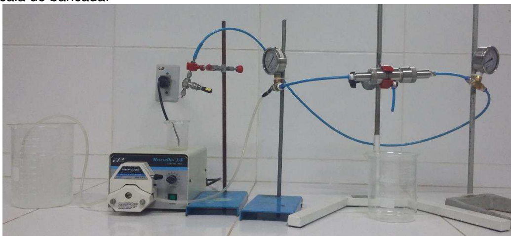
FIGURA 29 - Esquema do sistema de permeação de água e separação emulsão óleo/água em escala de bancada.
