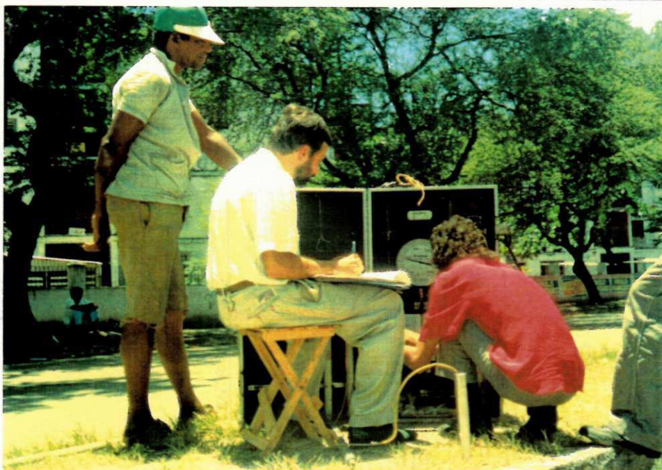
Fig. 27 - Av. Recife - Ensaio Pressiométrico (Sonda na Posição Vertical) Realizado no Canteiro Central (1990).
