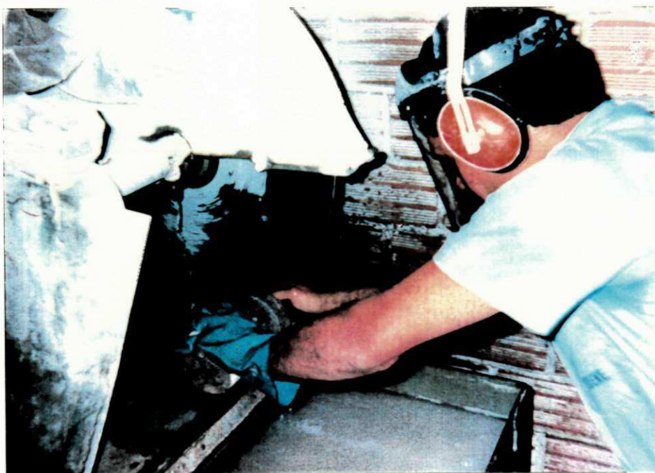
Fig. 43 - Detalhe do Corte de Regularização da Face Inferior dos Testemunhos Extraídos por Serra Diamantada (Laboratório de Análises Minerais da SUDENE/UFPE).
