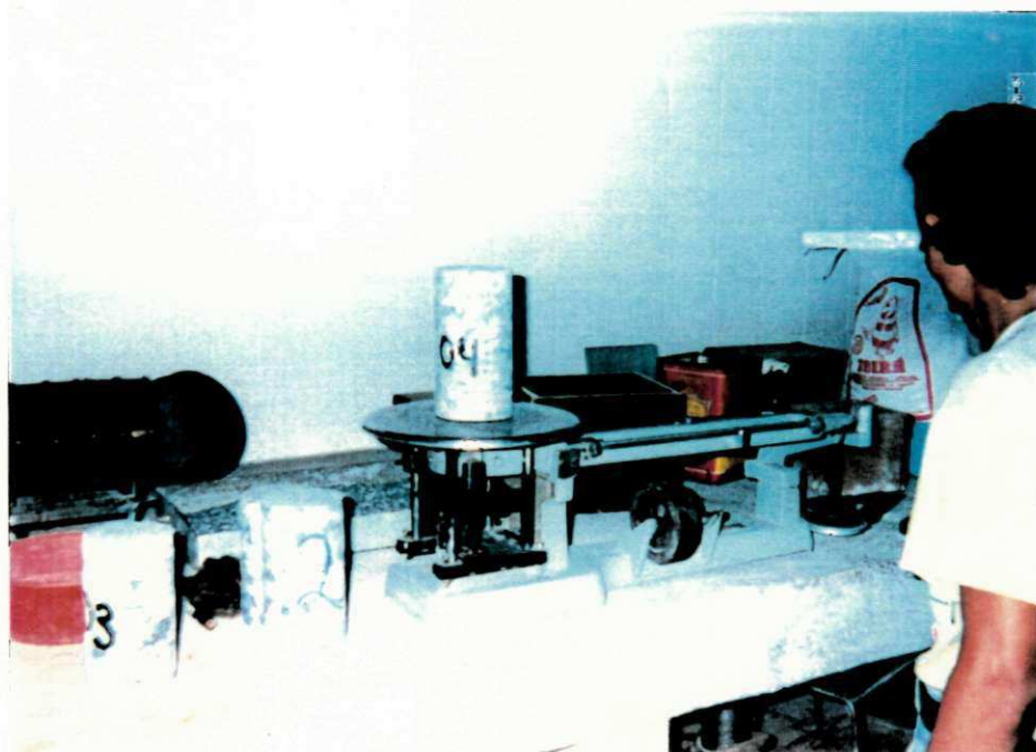
Fig. 44 - Pesagem dos Testemunhos Extraídos em Laboratório para Determinação da Massa Específica Aparente ou Massa Unitária do Concreto (1991).
