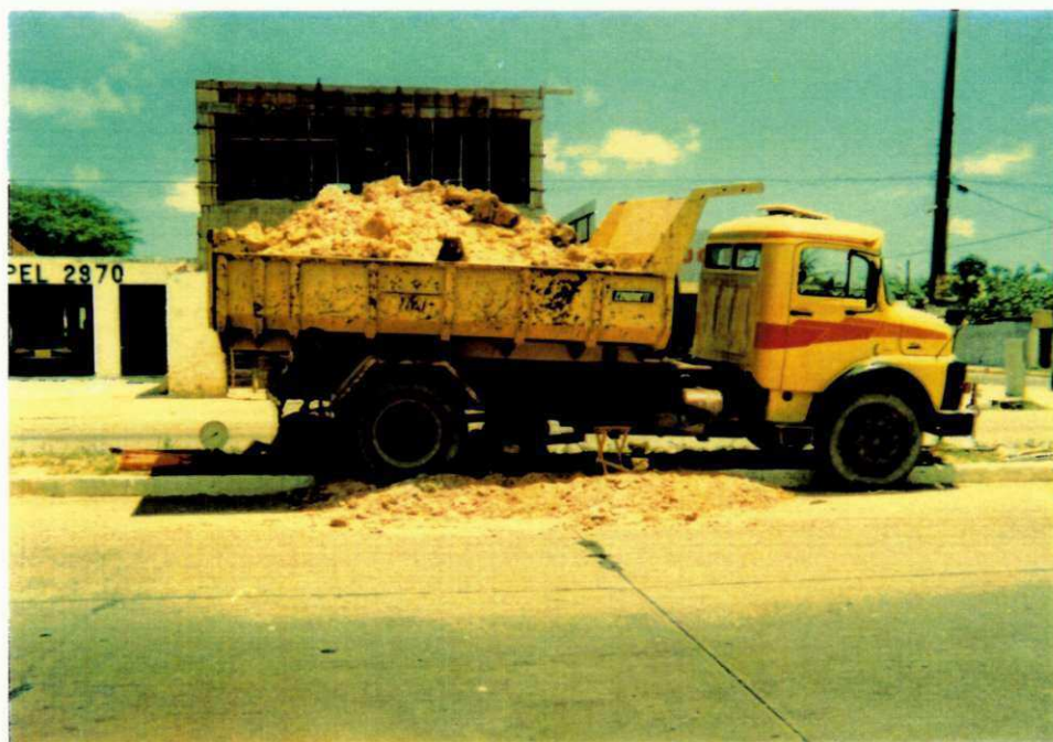
Fig. 20 - Av. Recife - Ensaio de Prova de Carga sobre Placas Realizado no Canteiro Central (1990).
