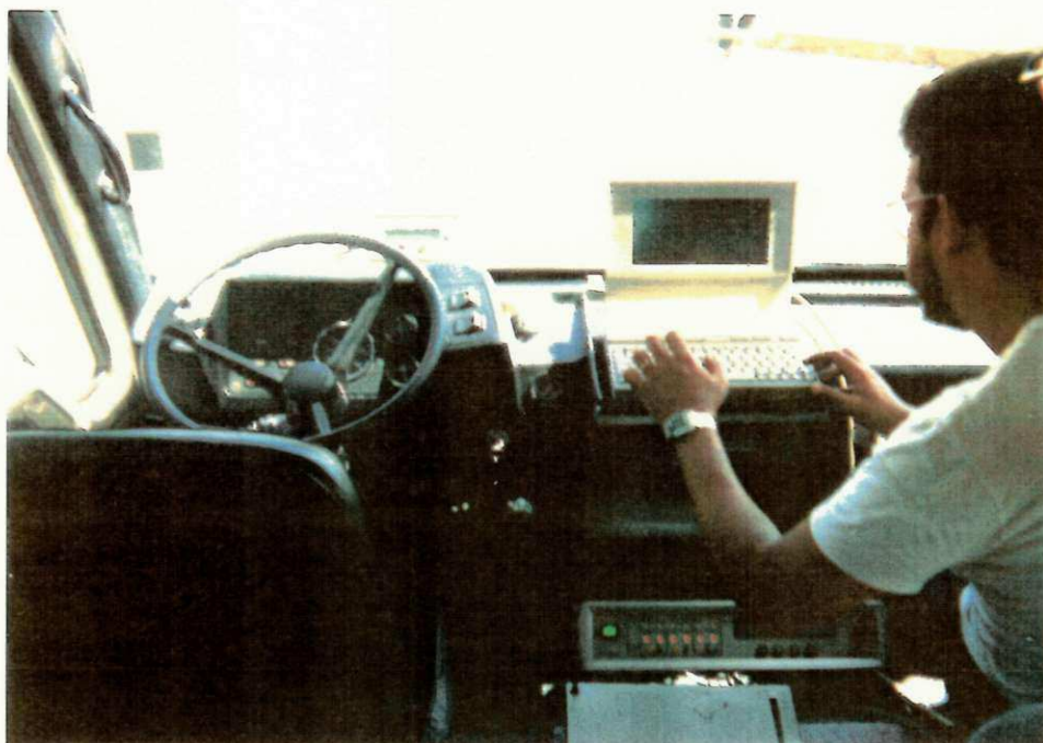
Fig. 80 - Av. Recife - Veículo-Teste com Detalhe do Microcomputador de Comando dos Ensaios com o "FWD" (Maio/92)
