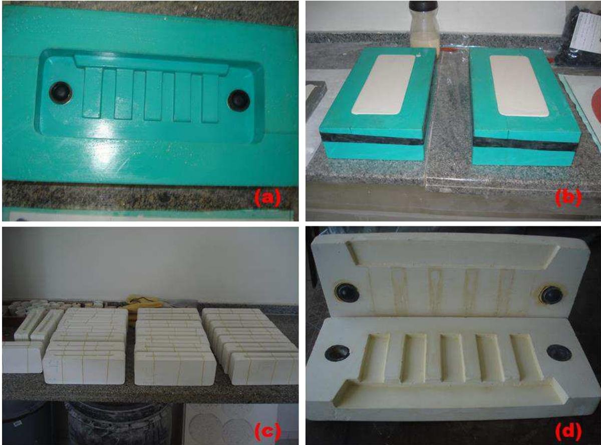
Figura 5. Processo de fabricação dos moldes de gesso (a) matriz aberta; (b) matrizes preenchidas pelo gesso antes do fim da pega final; (c) moldes de repouso antes de serem utilizados; (d) molde aberto após algumas fundições.
