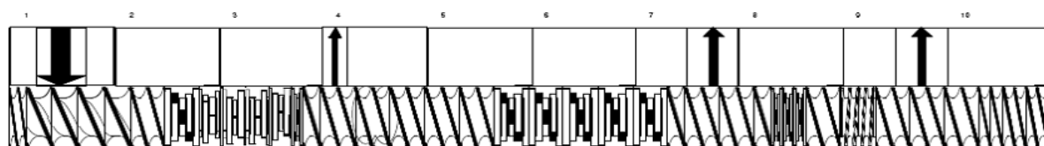
Figura 11 – Detalhe da configuração da rosca da extrusora contendo elementos dispersivos e distributivos.
