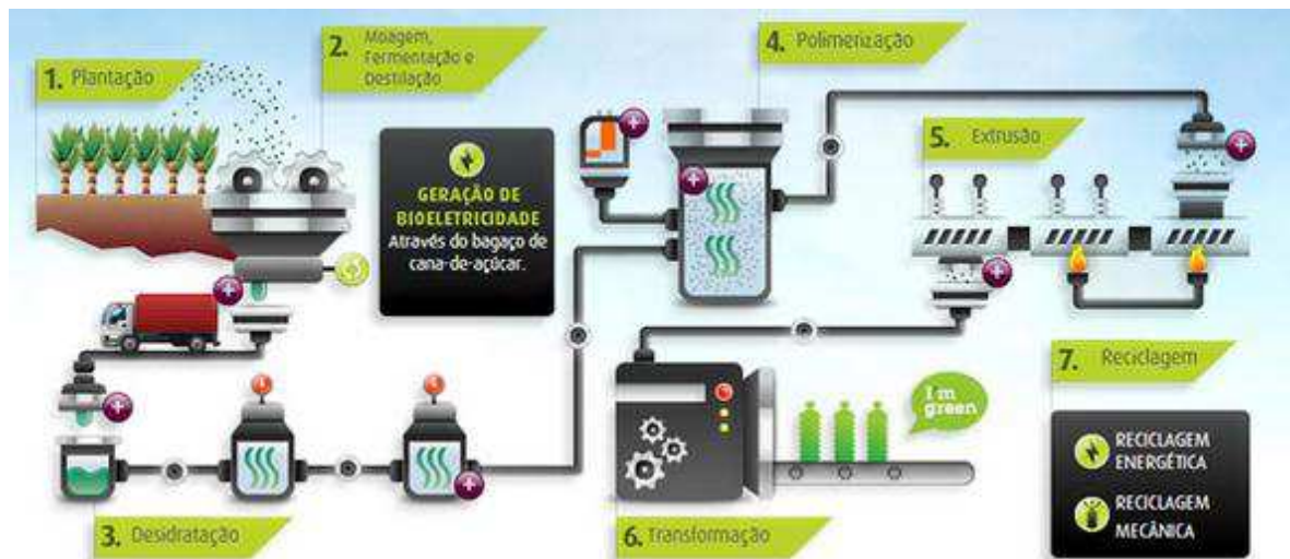
Figura 2 - Processo de produção do polietileno verde (Braskem, 2015).
