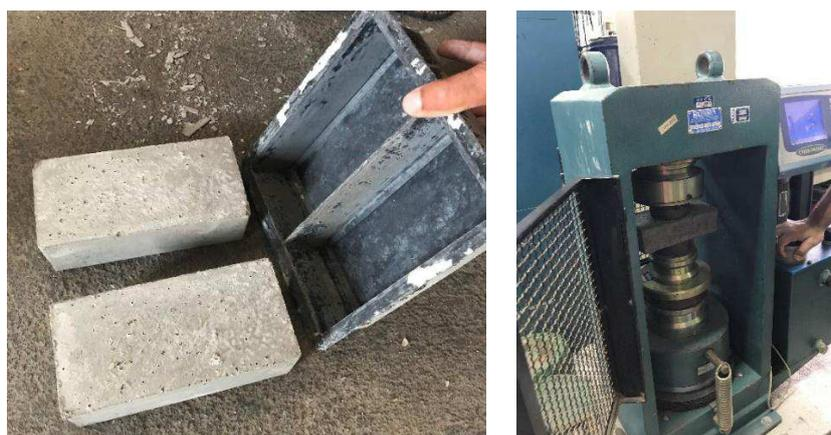
Figura 11 – Moldagem e rompimento de blocos de concreto
