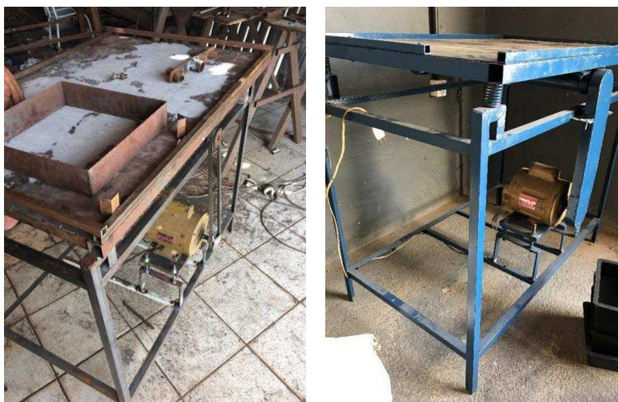
Figura 9 – Confeção de mesa vibratória elétrica
