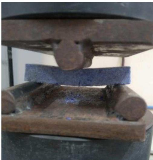
Figura 13 - Equipamento de ensaio universal Pulser SFL-100kN da Shimadzu durante a realização do ensaio de Flexão em três pontos. Fonte: Arquivo do autor
