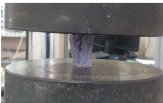
Figura 14 - Equipamento de ensaio universal Servo Pulser SFL-100kN da Shimadzu durante a realização do ensaio de Compressão. Fonte: Arquivo do autor.
