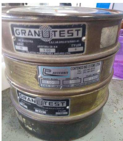
Figura 8 - Execução do método de peneiramento fino Fonte: Arquivo do autor.
