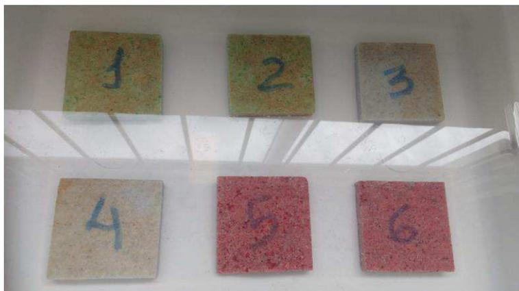
Figura 12 - Corpos de prova durante o ensaio de absorção de água. Fonte: Arquivo do autor.
