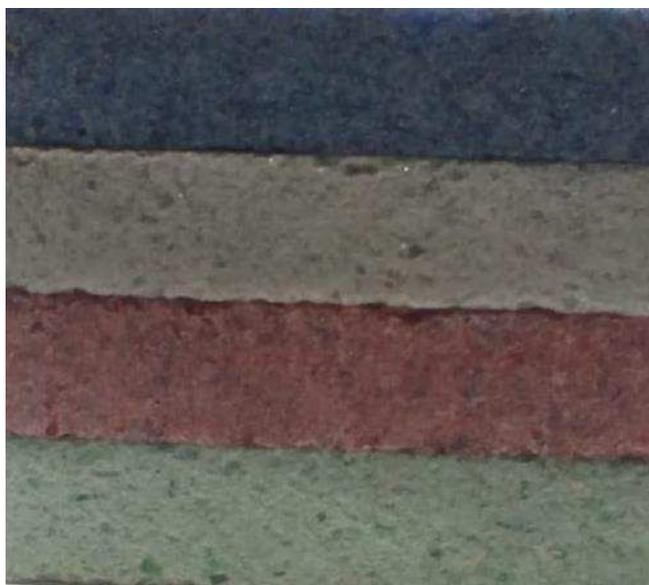
Figura 16 - Aparência visual dos compósitos de resina poliéster com pó de vidro. Fonte: Arquivo do autor.
