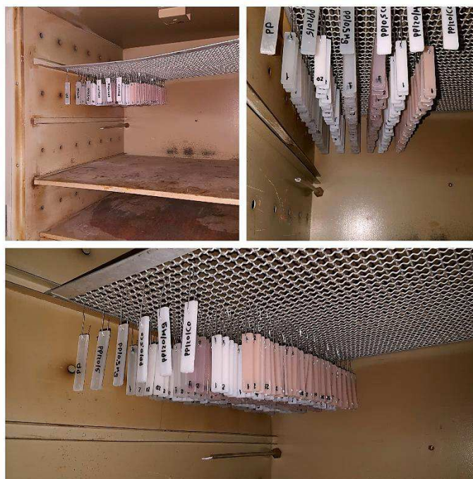
Figura 24 – Estufa de circulação forçada de ar para degradação térmica.
