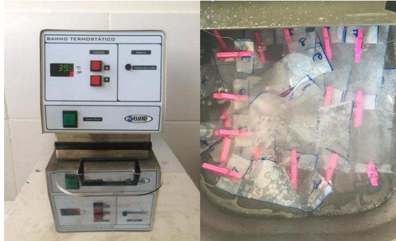
**Figura 9** – Equipamento do banho térmico e os filmes imersos no banho térmico.
