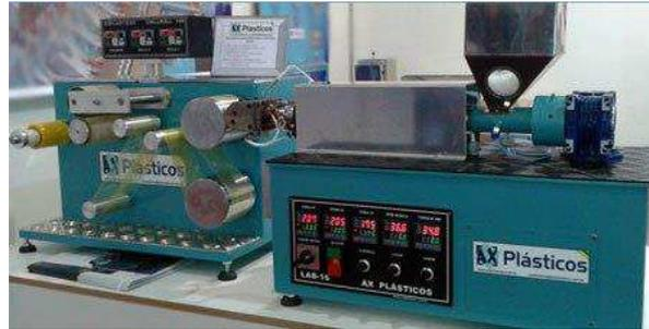
**Figura 7** – Extrusora de filmes poliméricos Chill roll AX Plásticos.
