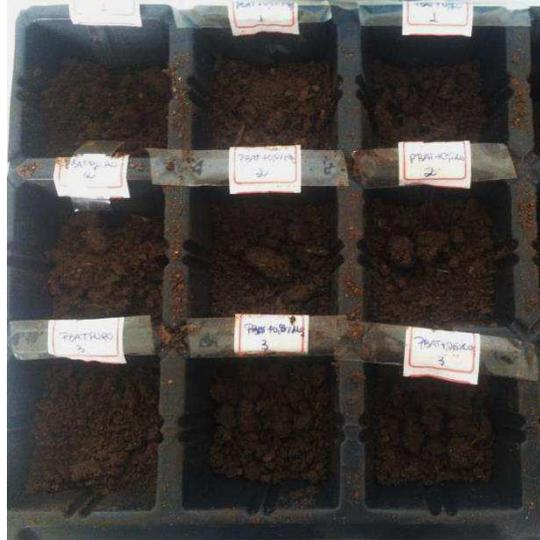
**Figura 8-** Compartimentos de plástico utilizado para ensaio de biodegradação.
