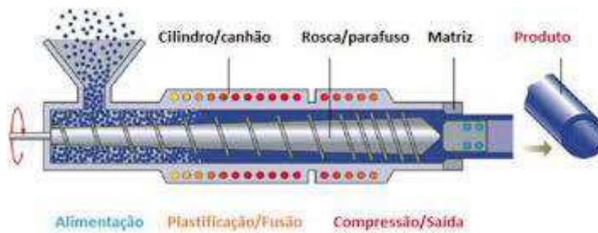
**Figura 5** – Esquema de uma extrusora com as diversas partes funcionais. Fonte: [www.abiplast.org.br](http://www.abiplast.org.br), 2019.
