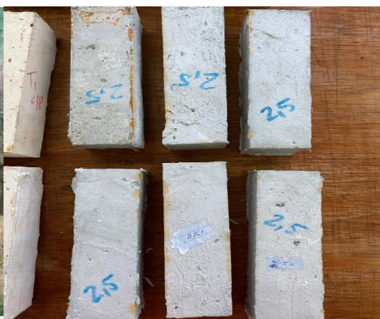
Figura 5. Corpos de prova confeccionados para análise do teste de resistência à flexão. Fonte: Autor, 2022.
