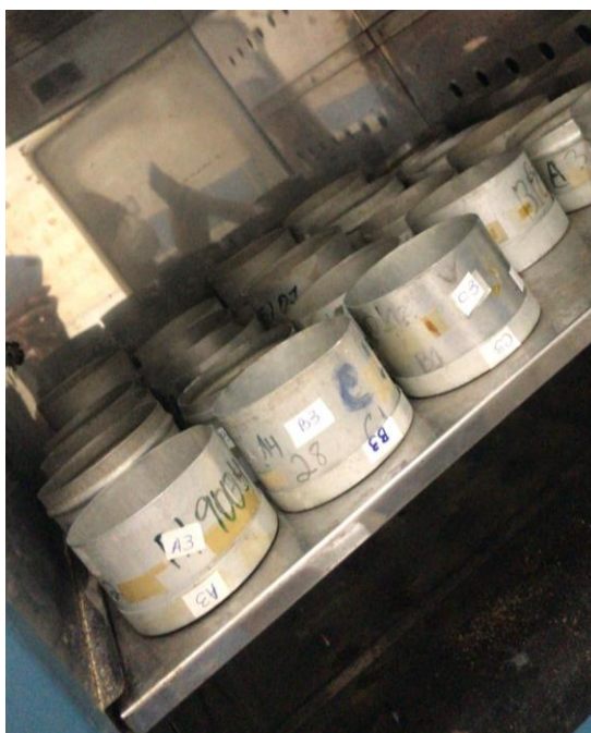
Figura 8. Amostras de resíduo de caju na estufa de circulação forçada de ar.
