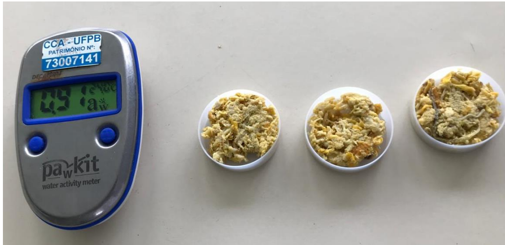
Figura 7. Aferição da atividade de água junto com a perda de massa.
