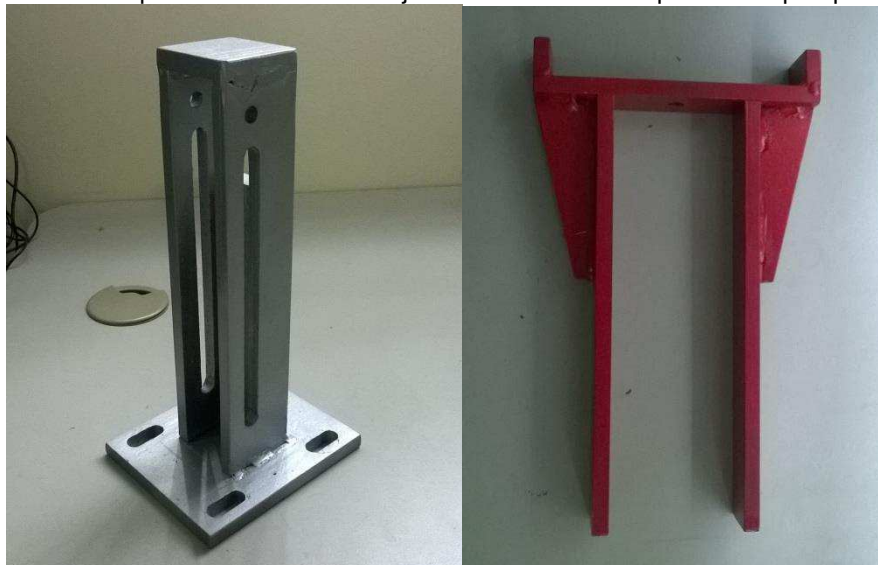
Figura 85 – Dispositivo DCB com conjuntos torre DCB e impactador após pinturas.
