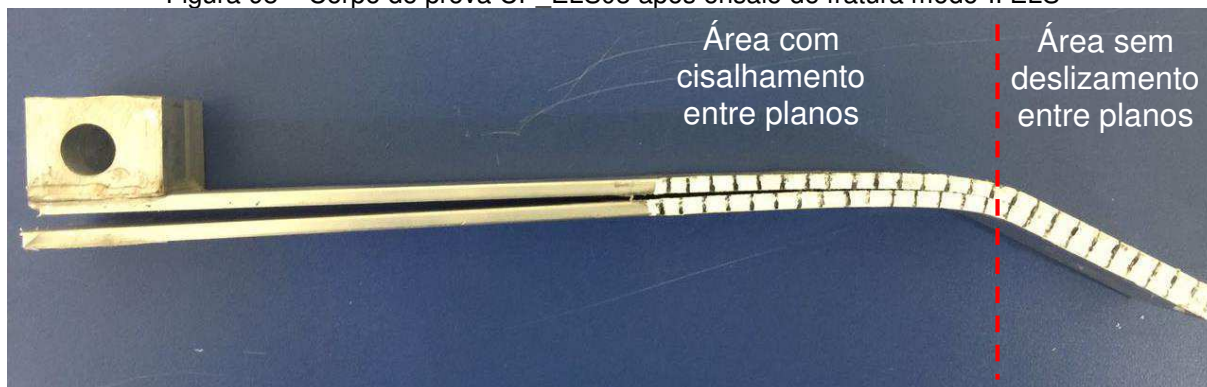
Figura 98 – Corpo de prova CP_ELS03 após ensaio de fratura modo-II ELS
