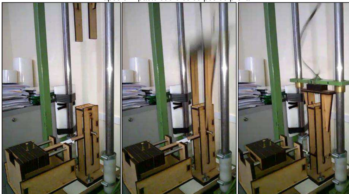
Figura 63 – Simulação de ensaio sobre o protótipo funcional ELS nos momentos anterior, durante e após o impacto sobre os corpos de prova
