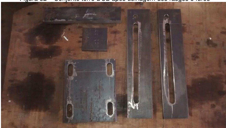
Figura 82 – Conjunto torre DCB após usinagem dos rasgos e furos
