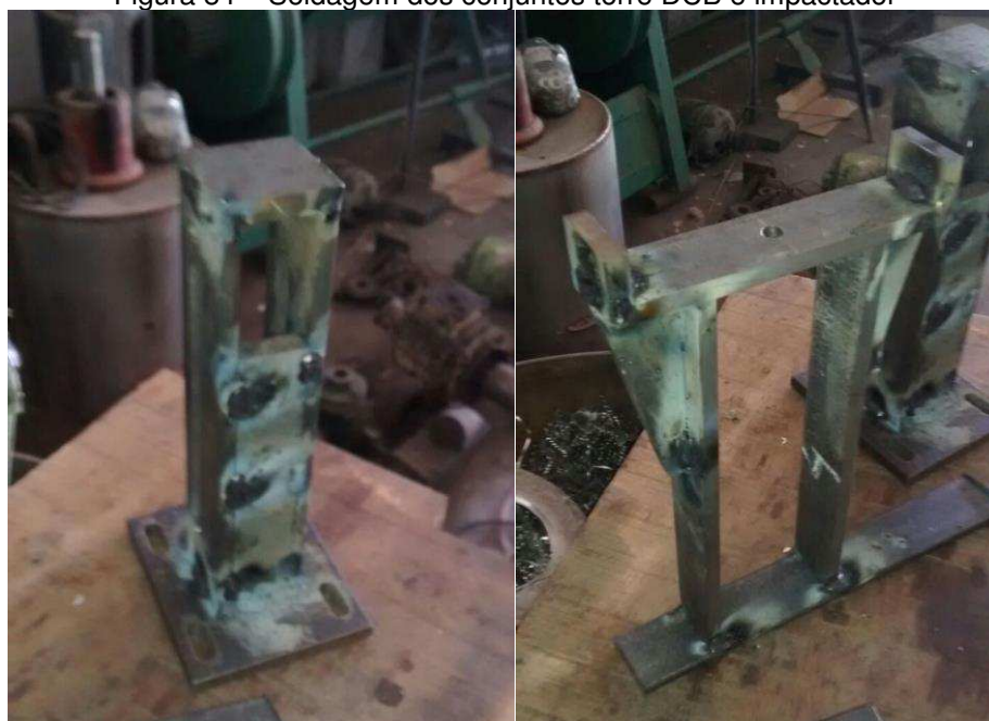
Figura 84 – Soldagem dos conjuntos torre DCB e impactador
