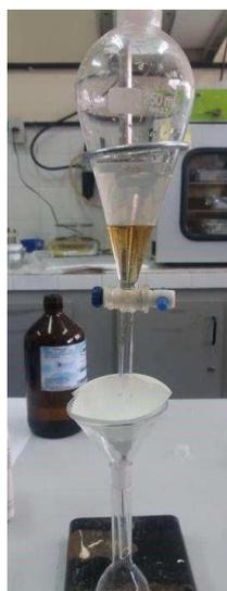
Figura 19 - Separação da água-óleo: inferior de clorofórmio + óleo e superior com a água da amostra coletada.
