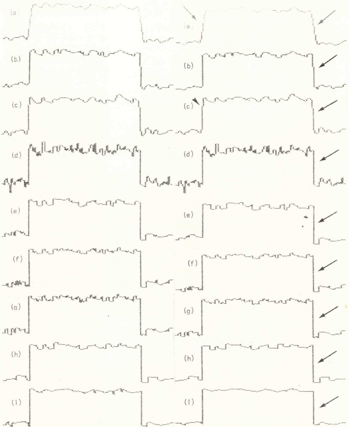
Figura 30. Perfis da linha de varredura 45 da imagem CÍRCULO com ruído gaussiano (0;20,0): (a)-(i) imagens filtradas (iteração 2) pelos algoritmos MEDIA, MEDIANA, MKVP, SCG, SVSV, SSDA, SMDA, FACET e SIGMA.
