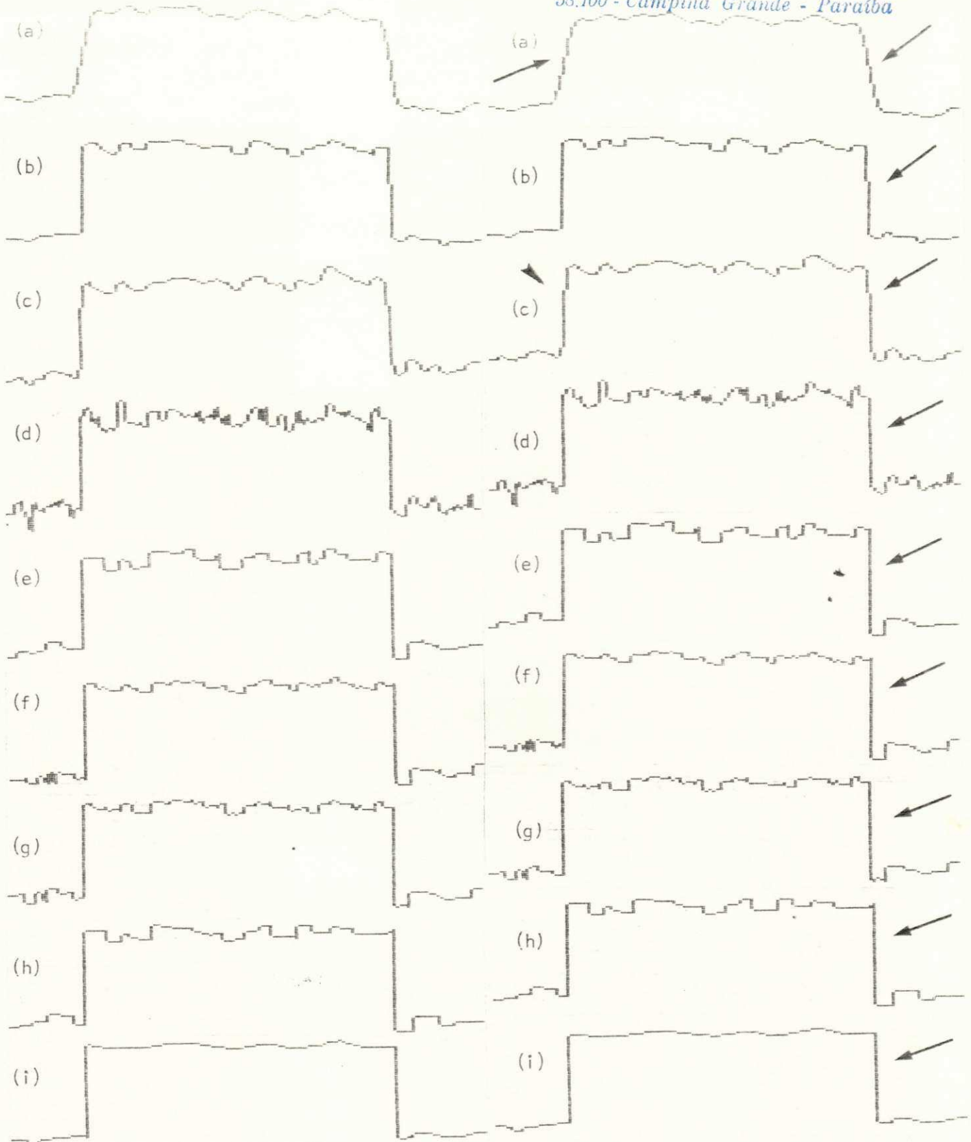
Figura 31. Perfis da linha de varredura 45 da imagem CÍRCULO com ruído gaussiano (0;20,0): (a)-(i) imagens filtradas (iteração 3) pelos algoritmos MEDIA, MEDIANA, MKVP, SCG, SVSV, SSDA, SMDA, FACET e SIGMA.
