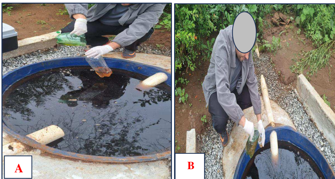
Figura 12: Coleta de amostra de água para pesquisa físico-química (A) e biológica (B)
