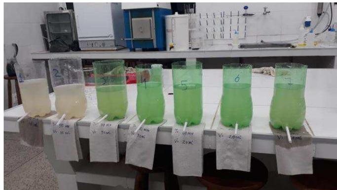
Ao término do processamento, alíquotas da água, antes e após os tratamentos, foram coletadas para realização das determinações físico químicas utilizando-se um turbidímetro (MS TECNOPON/CL-800), um pHmetro (QUIMIS/Q-400) e um condutivímetro (MS TECNOPON/Mca-150).
