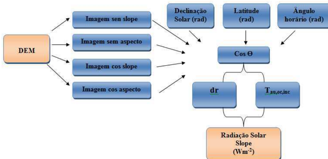
Figura 3.4 – Diagrama para o cálculo da radiação solar em superfície inclinada
