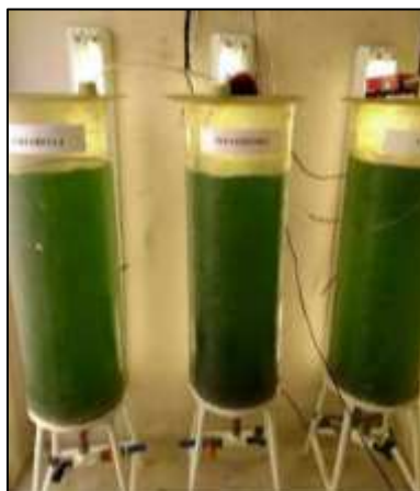
Figura 22: Fotobiorreatores tubulares utilizados para inóculos. Fonte: Autor
