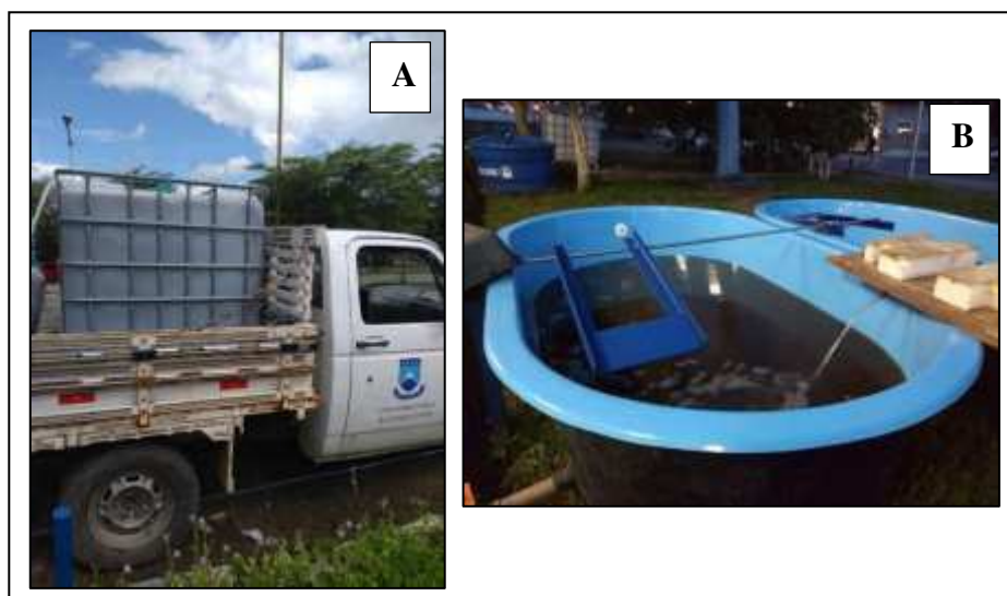
Figura 21: A – Tanque pipa contendo esgoto / B – Mistura água de poço e efluente de fossa séptica.
