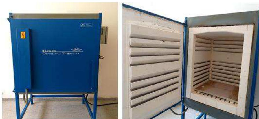
Figura 17 - Forno em que foram realizados os tratamentos térmicos.
