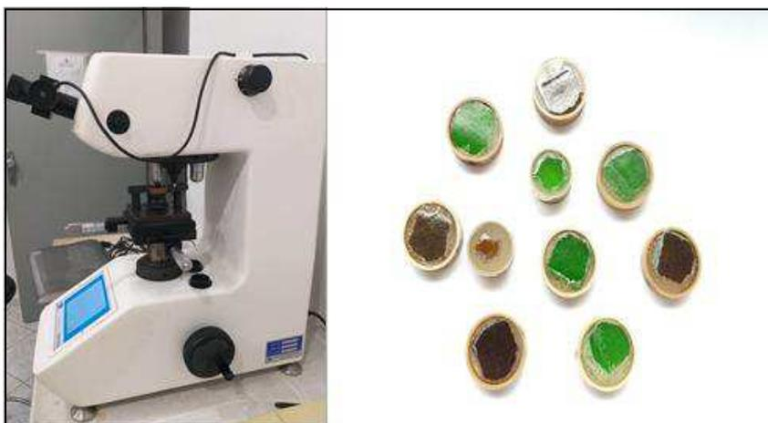
Figura 18 - Equipamento e corpos de prova do ensaio de microdureza Vickers.
