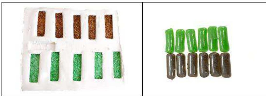
Figura 20 - Molde de gesso e corpos de prova do ensaio de impacto.
