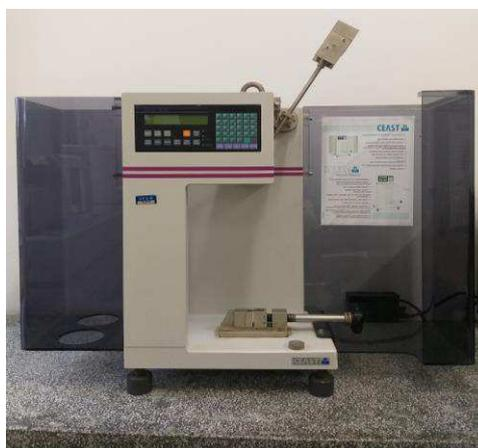
Figura 19 - Equipamento do ensaio de impacto.
