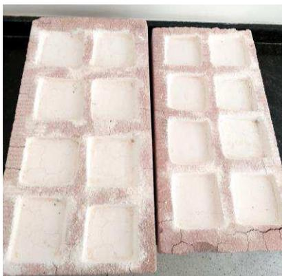
Figura 31 - Aspecto do molde após quatro queimas no forno.
