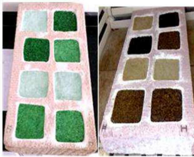
Figura 16 - Moldes preenchidos com as mesmas composições granulométricas para ambas as cores.
