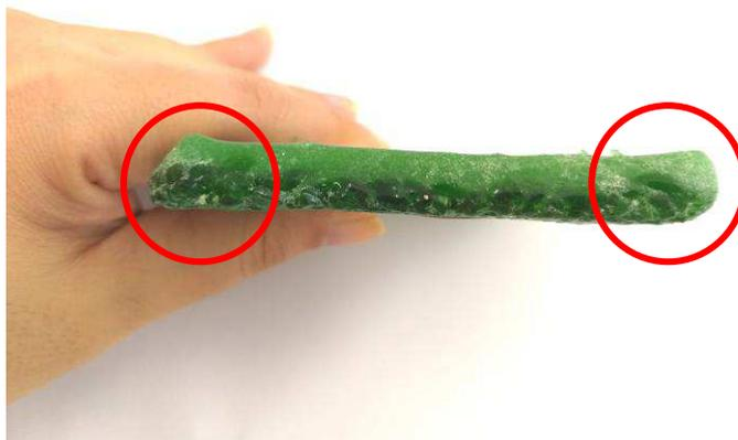
Figura 22- Chanframento das peças com menor granulometria na porção superior.
