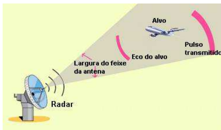
Figura 6 – Funcionamento do radar (Alves, 2018).
