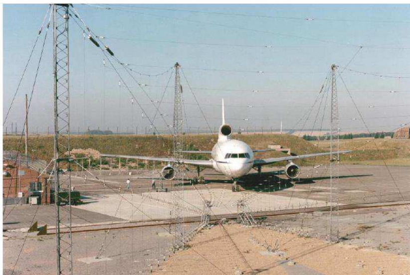
Figura 5 – Aeronave em um campo de testes de compatibilidade eletromagnética (Nohara, 2005).
