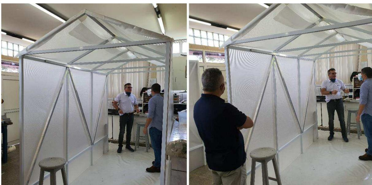
No primeiro protótipo parcialmente construído (Figura 6), houve a necessidade de projetar um sistema para as portas funcionais de forma que possibilite o transito de pessoas com diversas condições de mobilidade e ao mesmo tempo não altere o comportamento da distribuição do vapor no interior da cabine. Então, optou-se por utilizar cortinas que parcialmente se sobrepõem na entrada e na saída da cabine.
