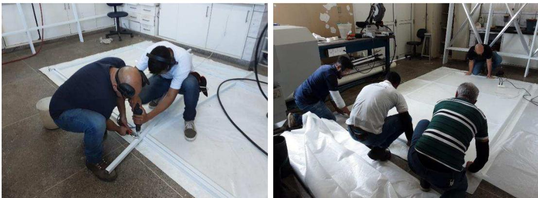
A estrutura possui barras metálicas de alumínio e é recoberto com material plástico de náilon reforçado próprio para o calor. O difusor fica na parte exterior lateral da cabine. O vapor produzido é transportado por uma mangueira de aço inox de 2 m de comprimento, a qual possui orifícios de 2 cm de diâmetro a distâncias regulares de 10 cm com a finalidade de otimizar a distribuição do vapor no interior da cabine.
