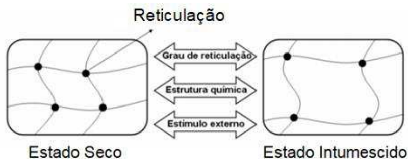
Figura 10 - Esquemas propostos para retículos de um hidrogel no estado seco e intumescimento. Note a expansão dos retículos ocasionada pela absorção de água (Aouada e Mattoso, 2009).
