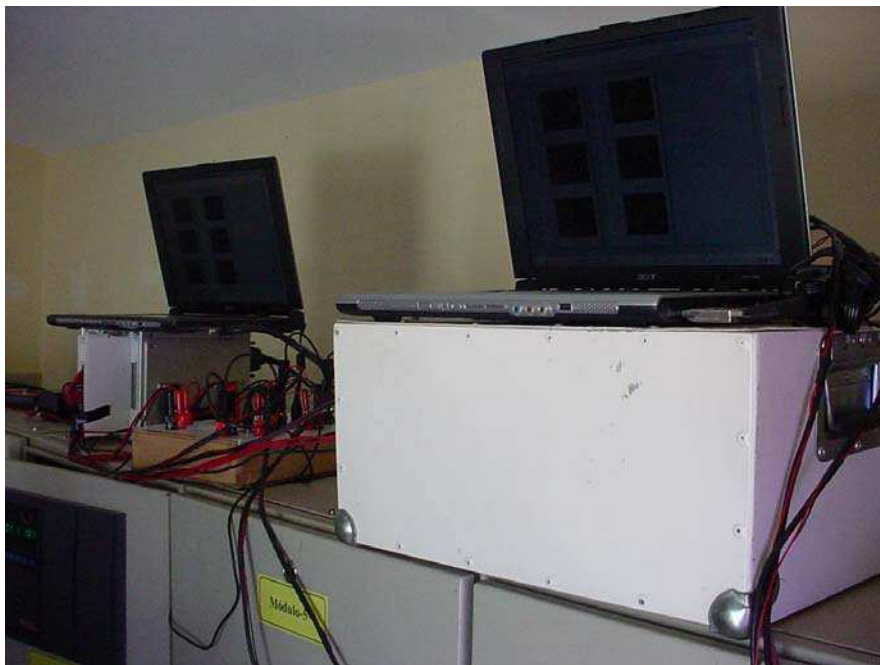
Figura A.5 – Fotografia do arranjo da medição para duas unidades consumidoras, com dois computadores sincronizados.
