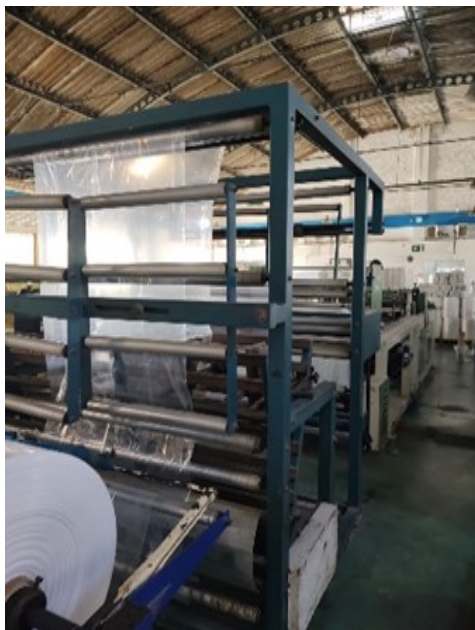
Figura 12 - Corte e solda em funcionamento
