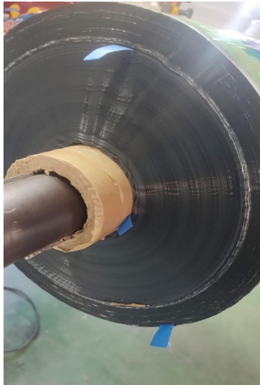
Figura 21 - Identificação das falhas na bobina.
