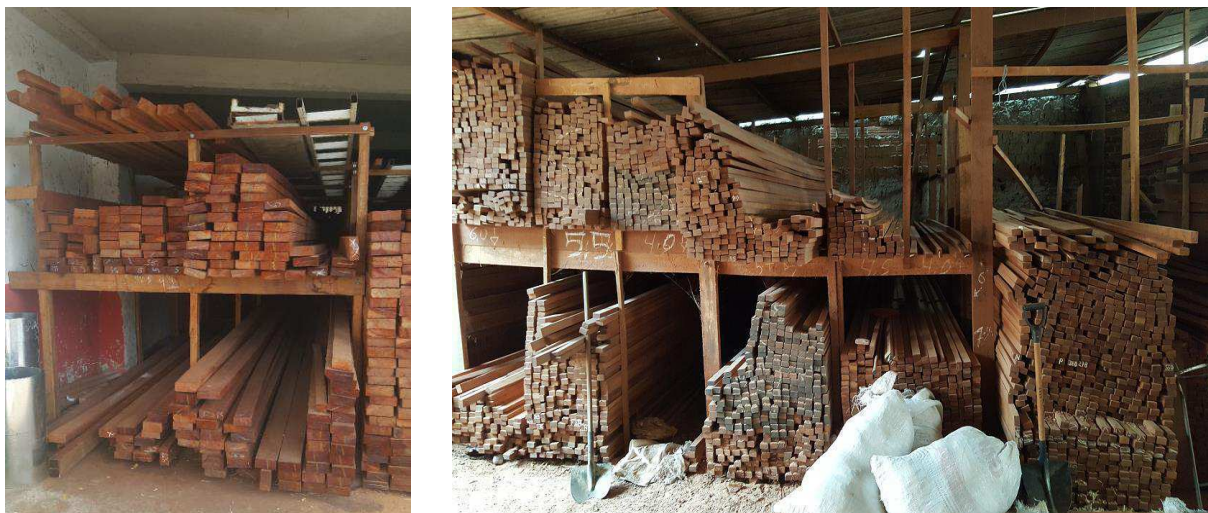
Figura 10 – Forma de armazenamento incorreta da madeira nos estabelecimentos na cidade de Patos - PB (2017)
