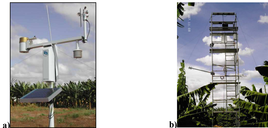
Figura 4: a) Estação meteorológica automática instalada dentro da área experimental; b) Torre contendo o sistema de correlações turbulentas instalado no pomar de bananeiras, localizados na fazenda Frutacor, Quixeré-CE.
