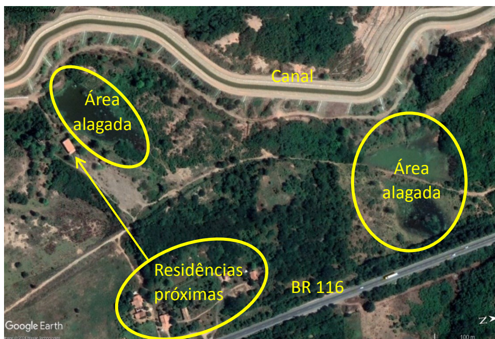
Figura 8 - Áreas afetada por alagamentos causados por vazamentos.
