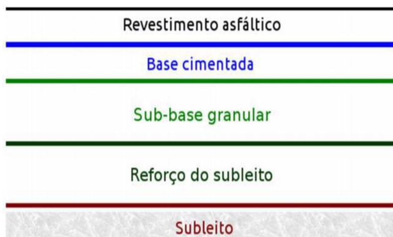
Figura 4 - Estrutura dos pavimentos semirrígidos
