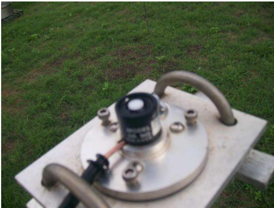
**Figura 11** - Sensor de radiação solar global da PCD instalada no município de Capim - PB.
