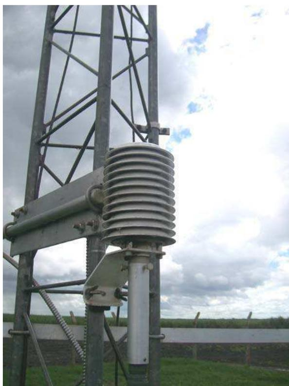
**Figura 10** - Sensores de temperatura e umidade relativa do ar da PCD instalada no município de Capim - PB.
