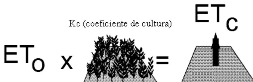
**Figura 8** - Esquema representando a evapotranspiração da cultura.<sup>11</sup>
