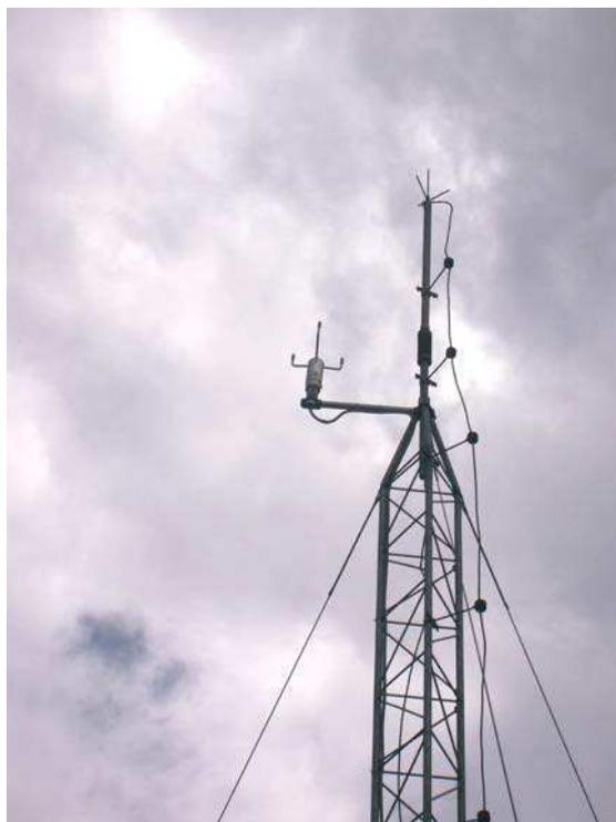
**Figura 9** - Sensor ultra-sônico da PCD instalada no município de Capim - PB.
