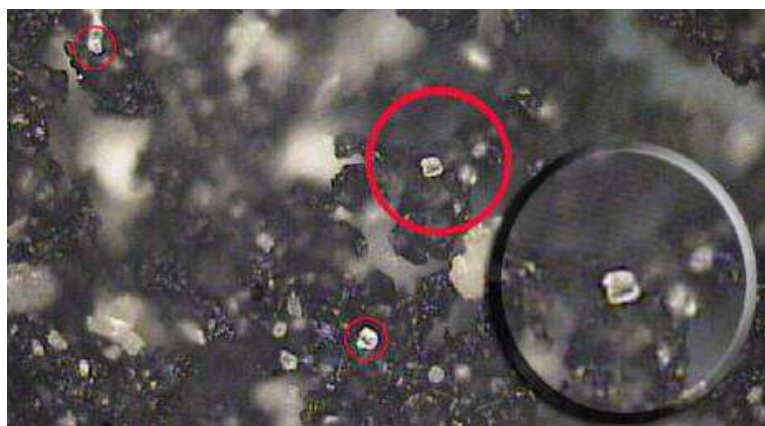
Figura 30 - Microscopia ótica da amostra do composto de EVAR preto passante na Malha 100 (aumento 100x)
