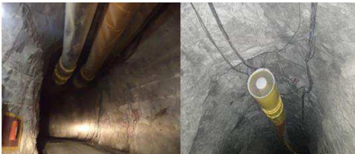
**Figura 4.9 - Ventilador secundário e dutos de ventilação.**
