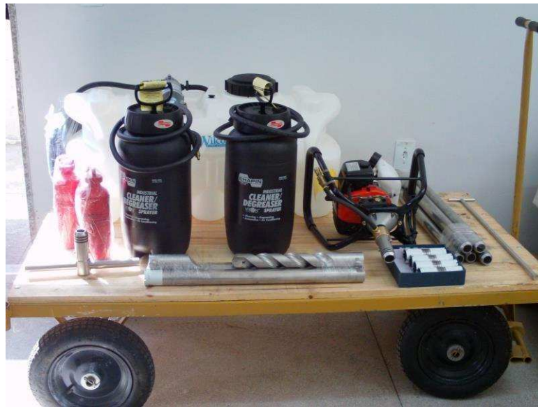
Figura 28: Plugadeira portátil de campo do laboratório de Petrofísica da UAMG.
