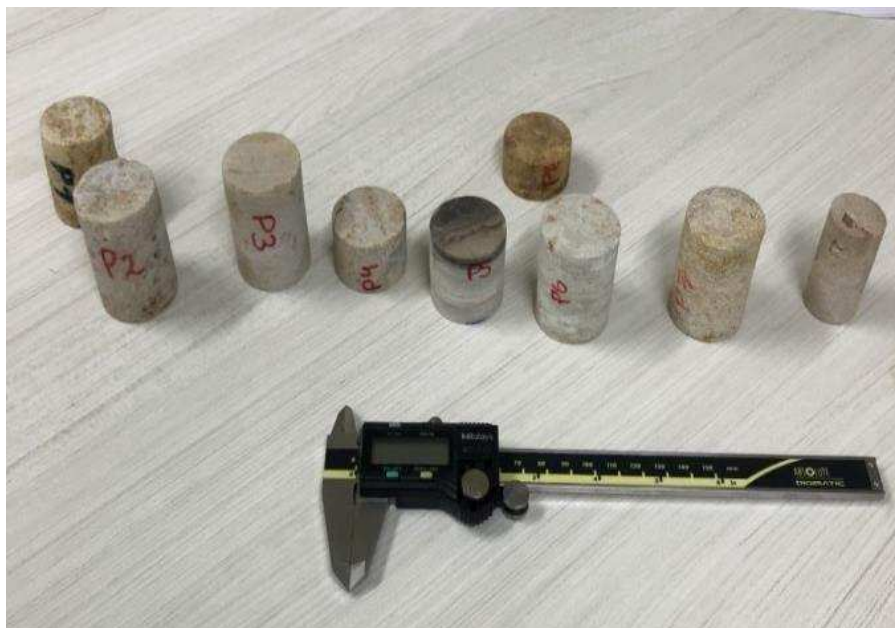
Figura 30: Plugues preparados para análise petrofísica.
