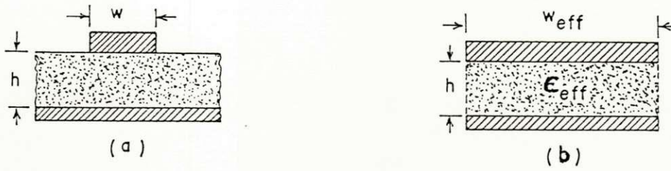
Figura 2.1: A linha de transmissão de microfita: a) Modelo do guia de ondas, b) Microfita final usando a técnica do mapeamento conforme.
