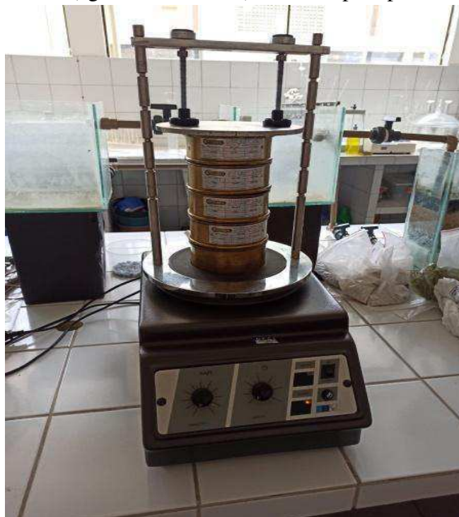
Figura 11 - Equipamento (agitador mecânico) utilizado para peneiramento dos materiais.
