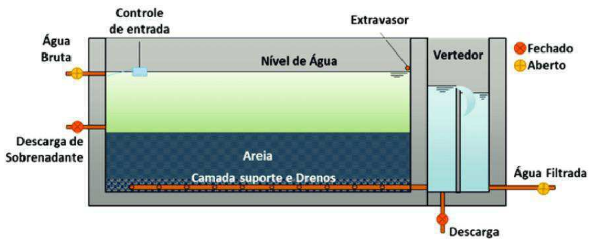
Figura 2 – Principais partes constituintes de um filtro lento
