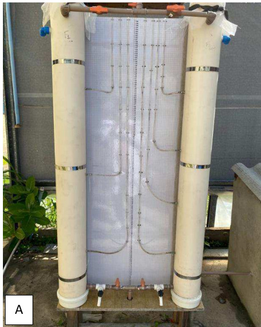
Figura 8 – Filtros lentos (a) e calha de coleta instalada no sistema de filtração lenta (b).
