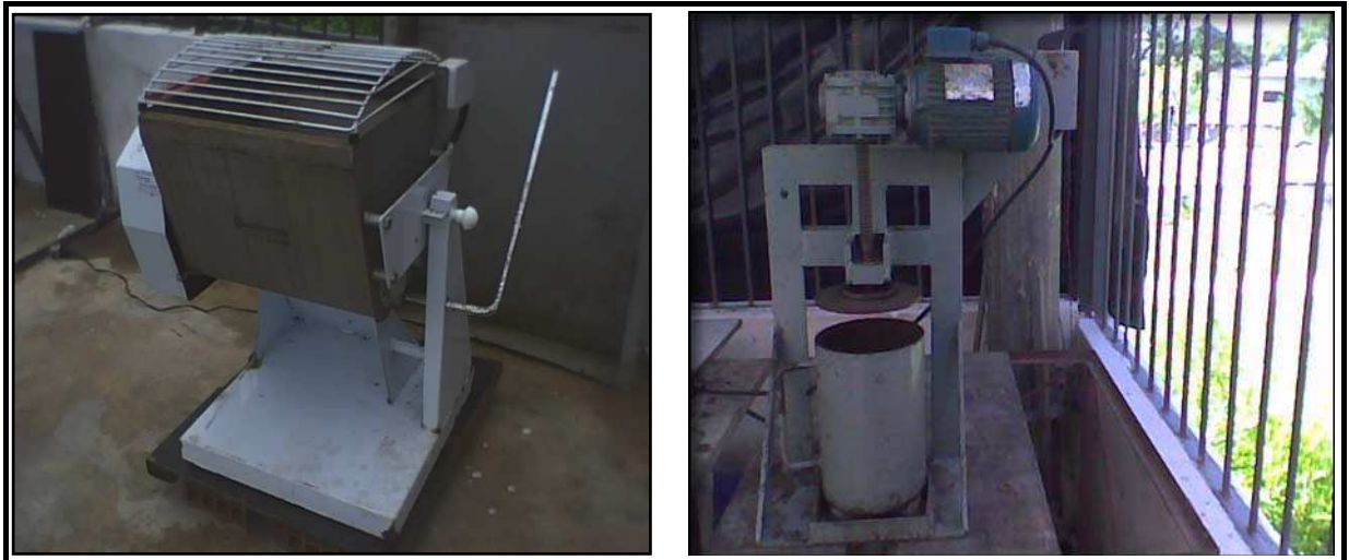
• FIGURA 3.4 – Ao lado esquerdo a máquina de misturar o bagaço com a torta. À direita a máquina prensa usada para fazer a separação do líquido contido na torta.
