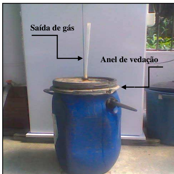
• FIGURA 3.1-Reator RUNDS e dispositivos de saída de gás e vedação do reator.
