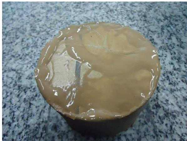
Os solos 02 e 03 tiveram pouca perda de água durante a compactação giratória e molharam apenas o papel filtro que neles continham, um exemplo pode ser visto na Figura 56 de um corpo de prova do solo 03.
