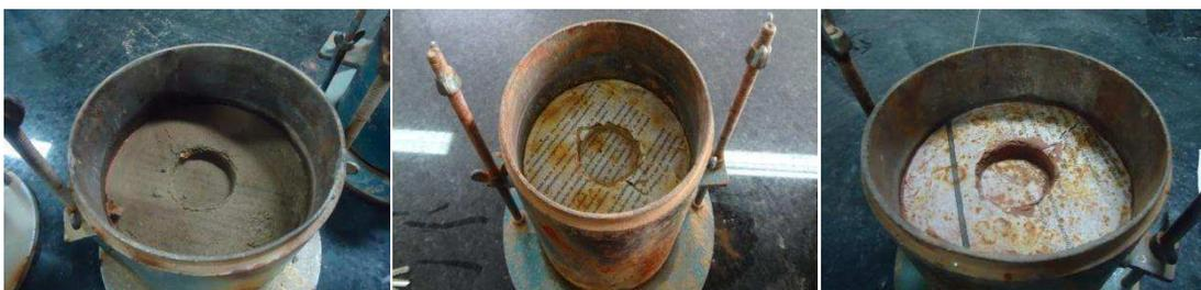
Como se pode notar nas Figuras 46 e 47 acima as penetrações visuais sofridas pelos corpos de prova dos três tipos de solos para os dois tipos de moldagem Proctor e CGS apresentaram penetrações semelhantes, não podendo então por este critério avaliar qual método teve maior influência na penetração.
