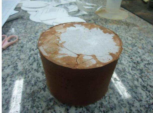
Duas foram as tentativas para se controlar a exsudação desta água durante a compactação giratória dos solos, para o molde cilíndrico de 100 mm de diâmetro foi utilizada uma pedra porosa e um papel filtro de mesmo diâmetro, e como se pode notar na Figura 54 para o solo 02 e 03 tivemos êxito. Para o molde cilíndrico de 150 mm de diâmetro apenas foi usado papel filtro em várias quantidades, e mesmo assim para o solo 01 estes ainda tiveram seu papel filtro bem úmido ao final da compactação.
