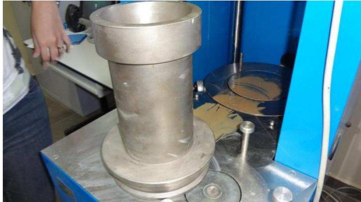
Tal fato é mais problemático para os solos mais grossos. A água expulsa dos vazios e pequenas quantidades de partículas de solo finas se reúnem na base de compactação. Estes depósitos de solo e água podem se acumular ao longo do tempo e causar o mau funcionamento do CGS. Além disso, a perda de partículas do solo podem criar erros nos valores de densidade seca computadas (Figura 55).
