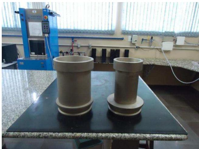
O Servopac foi desenvolvido em conformidade com os requisitos do Programa SHRP Superpave para projeto de mistura asfáltica. A máquina giratória tem quatro variáveis que são os principais fatores que afetam as características de compactação. As variáveis são: o ângulo de giro, a frequência de giros, a pressão vertical ou tensão normal, e o número de giros. A Tabela 3, apresenta os valores máximos e mínimos destas variáveis.
