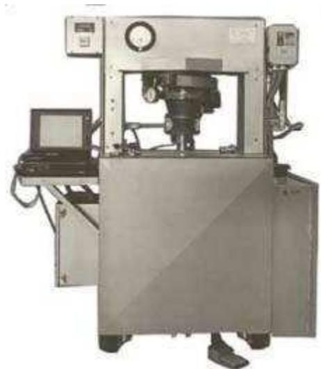
No compactador criado por J. L. McRae, o ângulo de giro era obtido por dois pontos, pois o intuito era fazer com que este ângulo oscilasse durante a compactação. O ângulo flutuante é medido durante a compactação e incorporado ao procedimento de projeto ao qual ele está associado. Além disso, o dispositivo captura a pressão no sistema de dois pontos e a altura da amostra (HARMAN et al., 2002).
