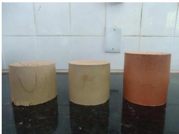
Os CPs moldados no CGS apresentaram uma menor altura do que as moldadas no Proctor, e consequentemente menor volume e maior massa específica. Portanto, infere-se que os corpos de prova sejam mais densos, uma vez que apresentam menores índices de vazios, do que os moldados no Proctor, justificando o aumento da resistência à compressão simples.
