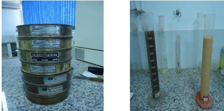
O ensaio de análise granulométrica é o processo utilizado para a determinação da porcentagem em peso que cada faixa especificada de tamanho de partículas representa na massa total ensaiada. Com os resultados obtidos desse ensaio é possível a construção da curva de distribuição granulométrica, importante para a classificação dos solos.
