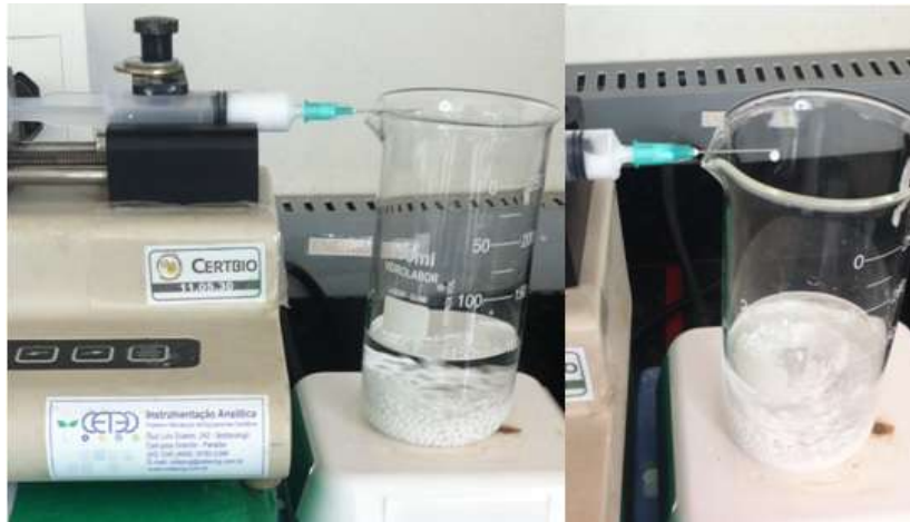
Figura 7: Sistema bomba de seringa para infusão única contendo pasta aquosa de polímeros e fosfatos de cálcio – FASE EXPERIMENTAL.
