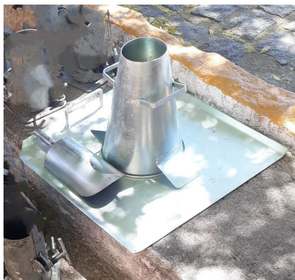
Figura 12 – Molde para Slump test
