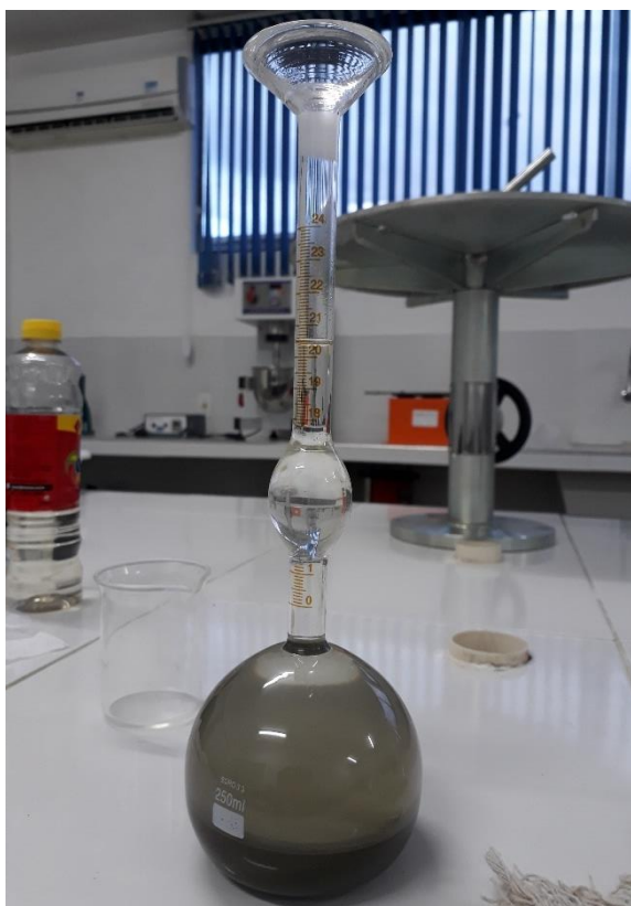
Figura 3 – Frasco volumétrico de Le Chatelier
