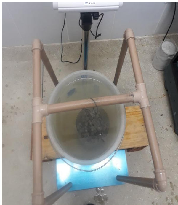
Figura 9 – RCD no cesto de arame
